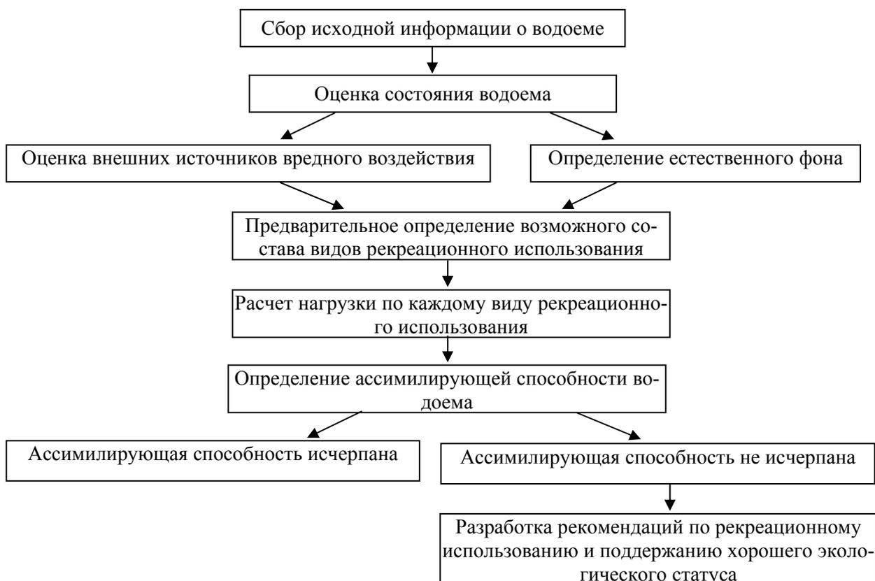
**Рисунок 1 – Алгоритм оценки степени возможной рекреационной нагрузки на водоем**
