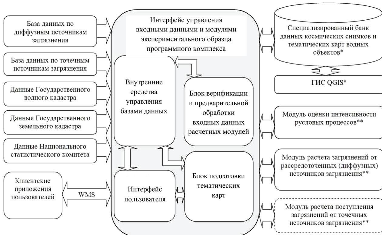
**Рисунок 1 – Структура экспериментального образца программного комплекса мониторинга русловых процессов и гидрологического режима рек с использованием данных ДЗЗ**
