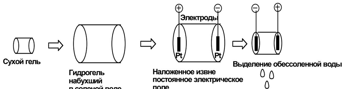
Рисунок 1 – Схема обессоливания воды
