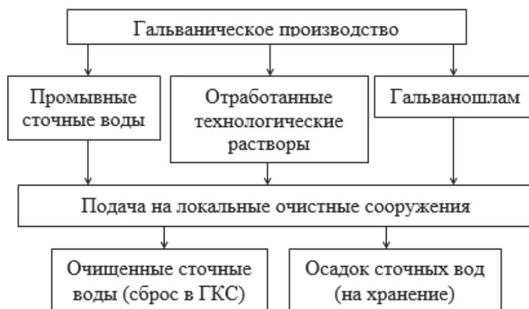
**Рисунок 1 – Существующая схема обращения с отходами гальванического производства**
