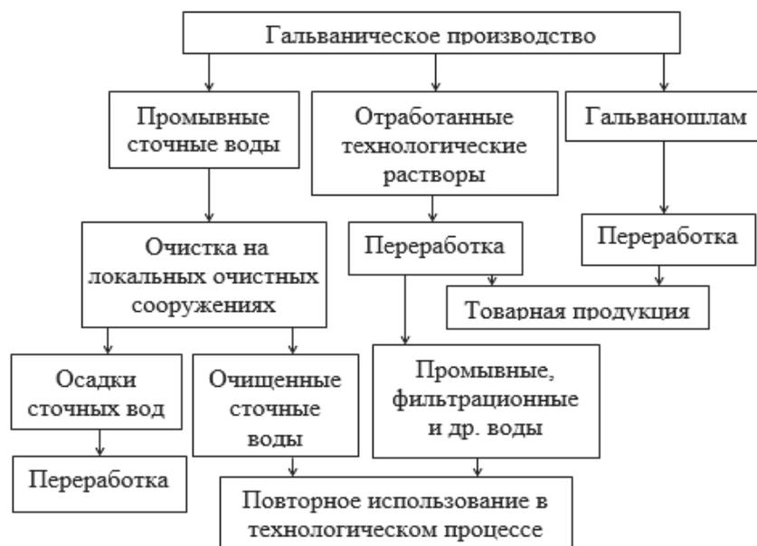
**Рисунок 2 – Предлагаемая схема обращения с отходами гальванического производства**
