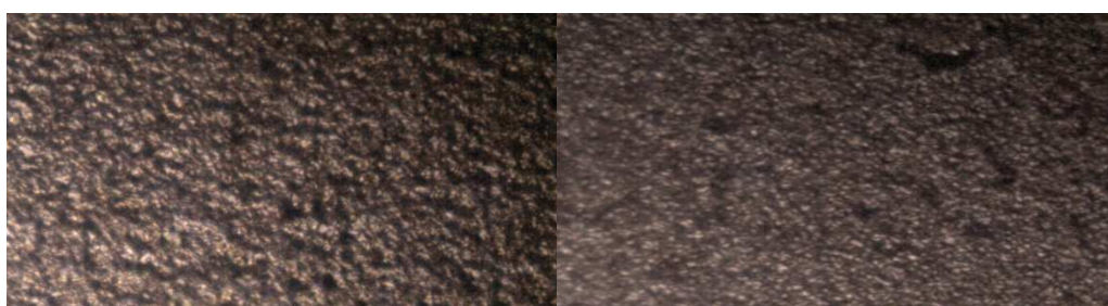
Рисунок 4 – Микрофотографии медных покрытий (x400)
