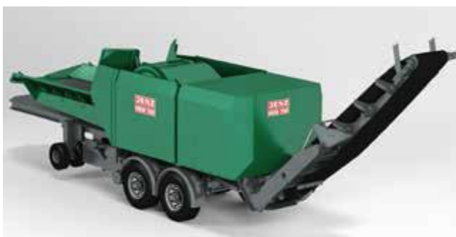
Рисунок 2 – Мобильные рубительные машины JENZ GmbH под седельный тягач
