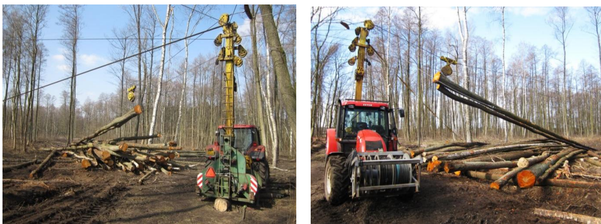
Рисунок 2 – Трелевка установкой Lagix 3T в полуподвесном положении
