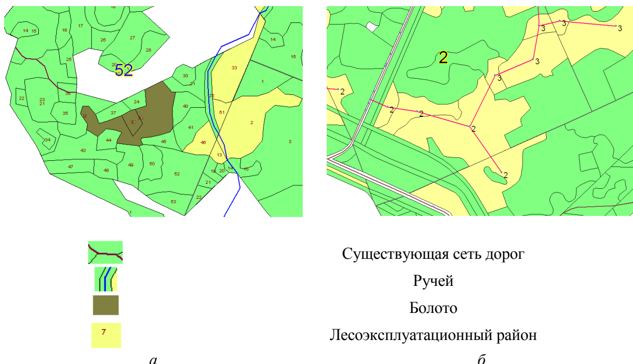
Рисунок 2 – Построение лесотранспортной сети
