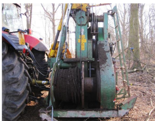
Рисунок 4 – Вода, смешанная с грязью и торфом, прилипла к канатной установке, канатам и всем металлическим частям
