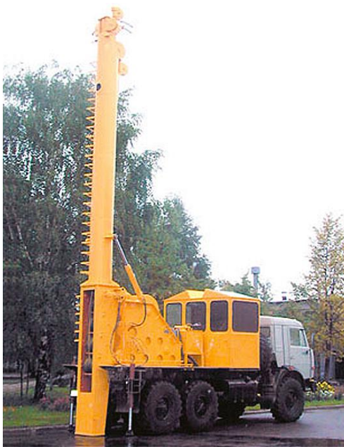
Рисунок 1 – Внешний вид трелевочной канатной установки МЛ-139
