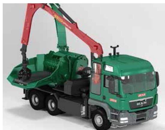
Рисунок 3 – Мобильные рубительные машины JENZ GmbH с приводом от двигателя грузовика
