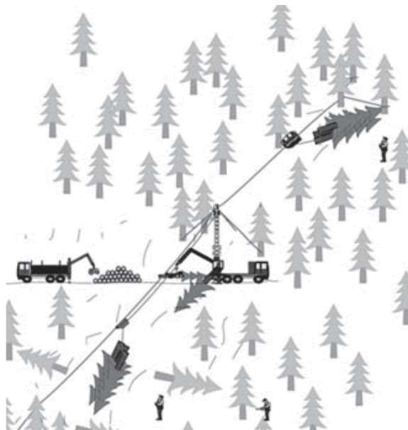
Рисунок 2 – Схема работы канатной установки
