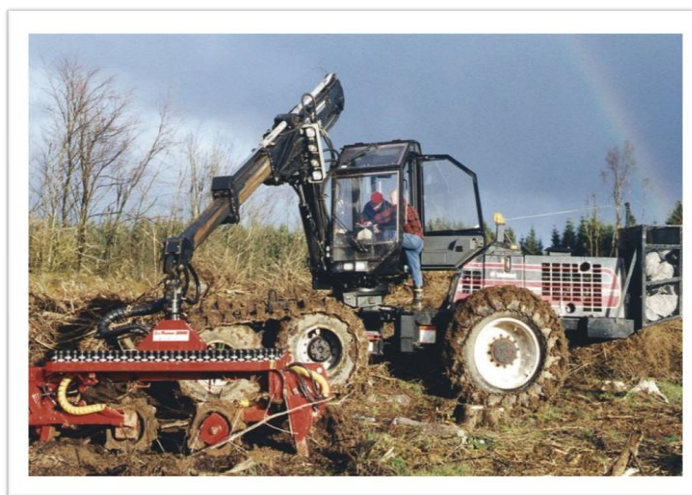
Рисунок 2 – Дискретный посадочный агрегат на базе харвестера
