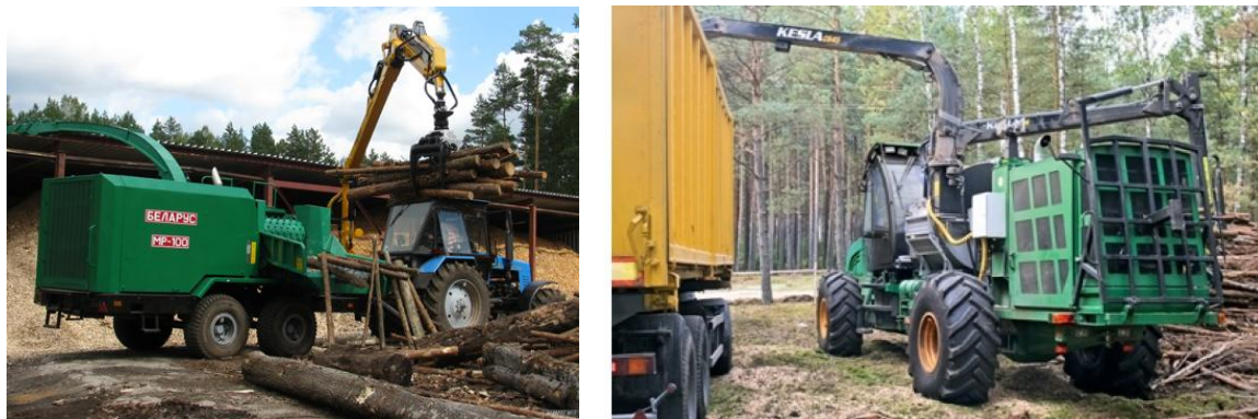
Рисунок 1 – Мобильные барабанные рубильные машины с гидроманипуляторами:
