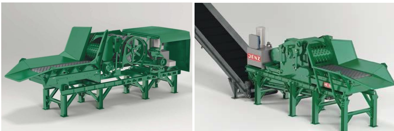
Рисунок 5 – Стационарные рубительные машины JENZ GmbH с электро двигателем
