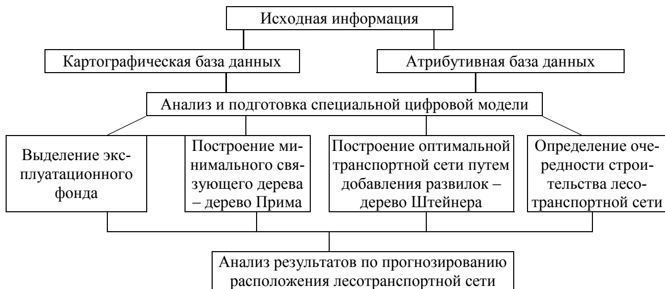
Рисунок 1 – Структурная схема по прогнозированию расположения лесотранспортной сети
