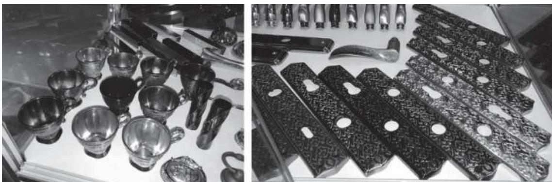
**Фото 3 – Детали с электрофоретическим покрытием**
