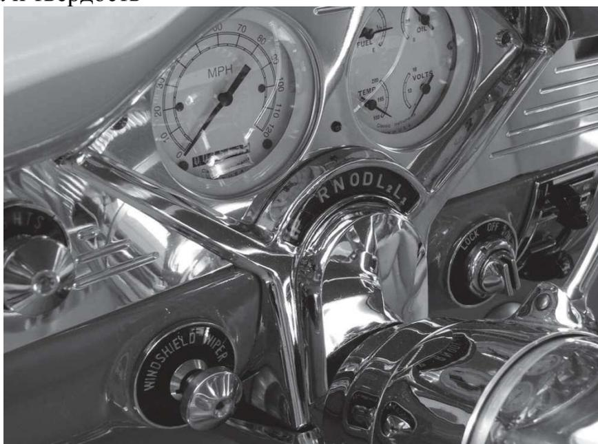
Фото 1 – Деталь с покрытием блестящее никелирование
