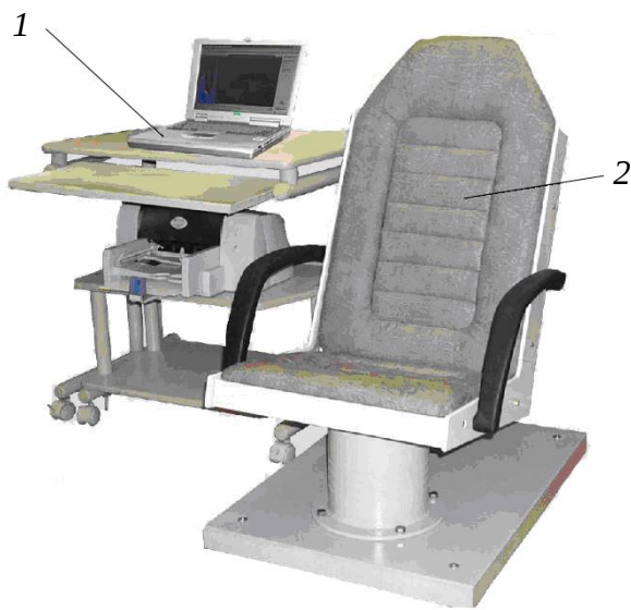
Рис. 12. Спектрометр излучения человека СКГ АТ 1316: 1 – персональная ЭВМ; 2 – диагностическое кресло с встроенными детекторами (сцинтилляторами)
