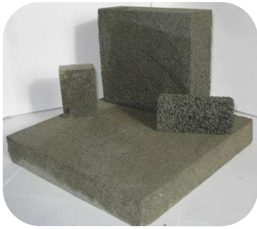
Рисунок – Блочный (1,3) и гранулированный (2) пеностеклянный материал на основе апатито-нефелиновых отходов (1) и микрокремнезема (2, 3)
