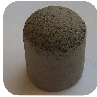
Рисунок – Блочный (1,3) и гранулированный (2) пеностеклянный материал на основе апатито-нефелиновых отходов (1) и микрокремнезема (2, 3)
