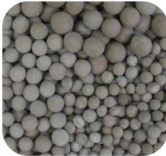
Рисунок – Блочный (1,3) и гранулированный (2) пеностеклянный материал на основе апатито-нефелиновых отходов (1) и микрокремнезема (2, 3)
