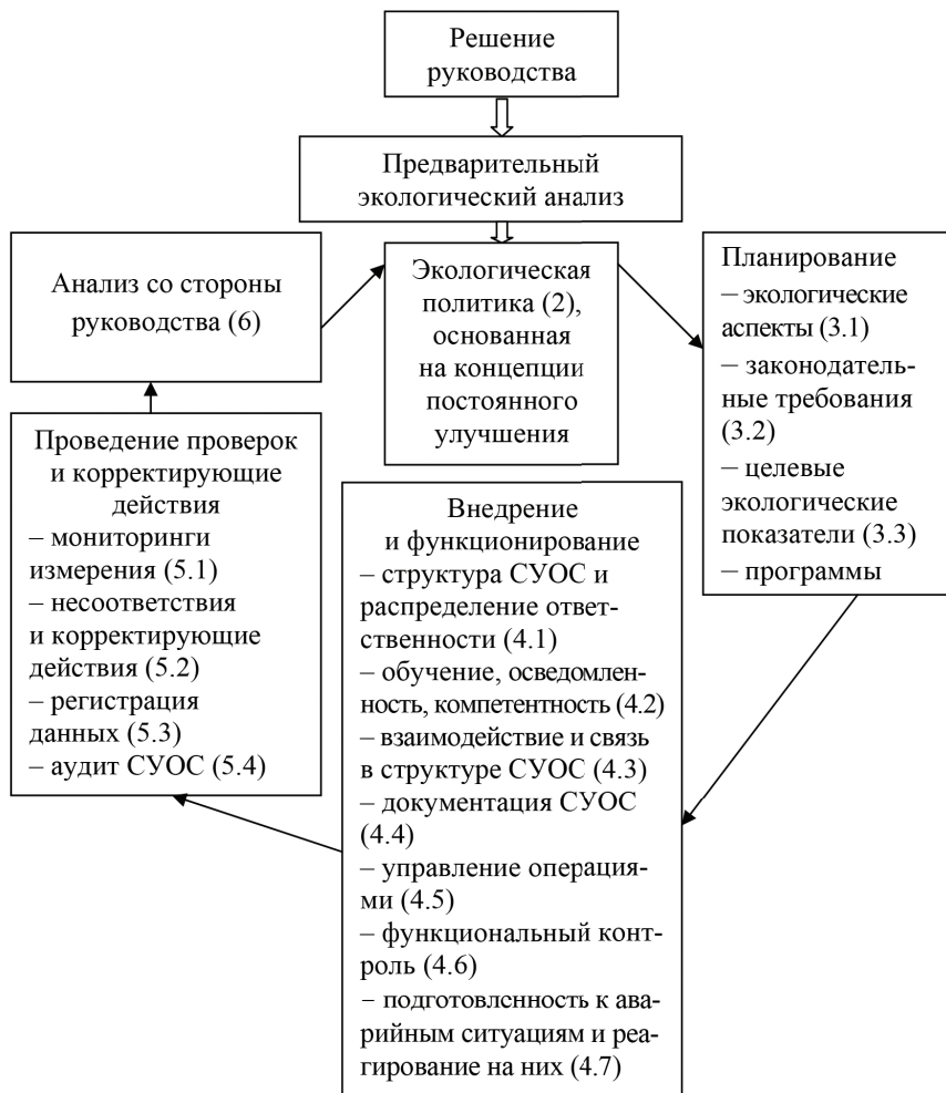
Рис. 14.4. Основные элементы (этапы создания) системы управления окружающей средой (номера элементов – по ИСО 14001)
