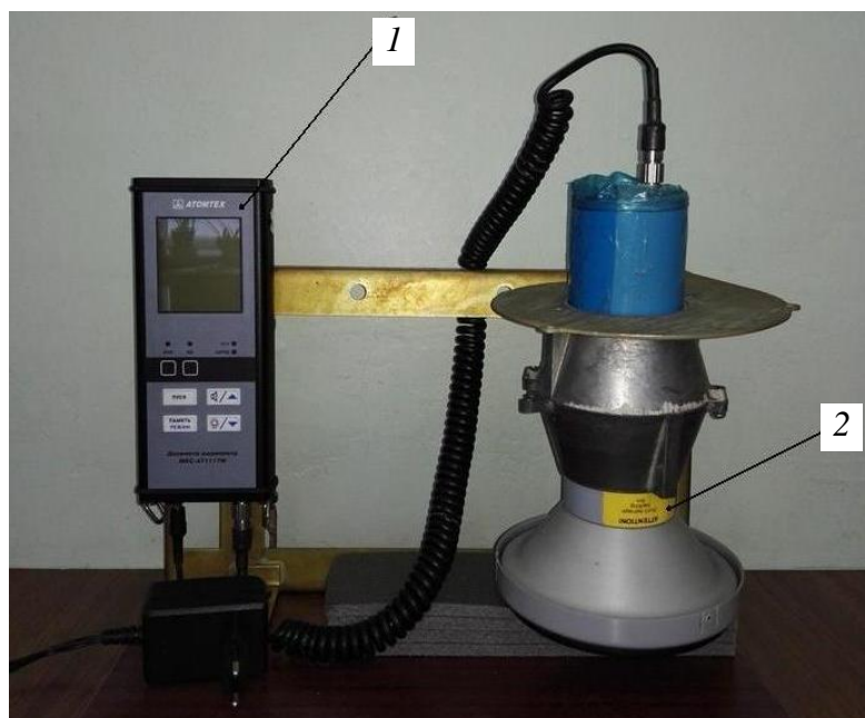
Рис. 17.3. Дозиметр-радиометр МКС-АТ1117М: 1 – блок обработки информации; 2 – блок детектирования БДПА-02
