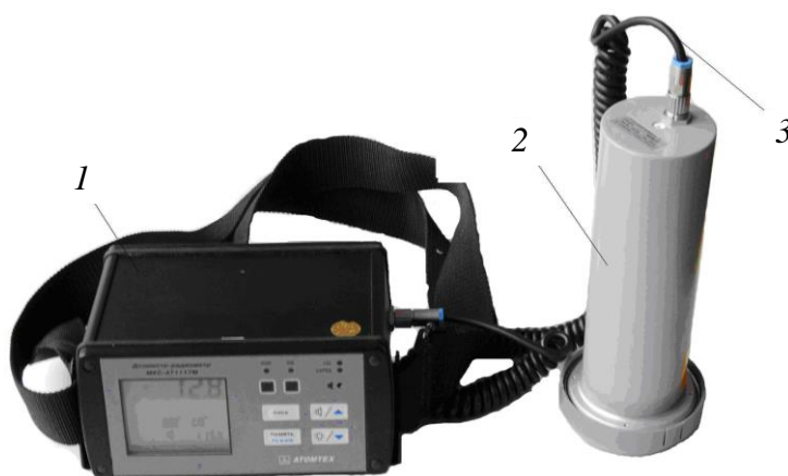
Рис. 14.2. Дозиметр-радиометр МКС-АТ117М: 1 – блок обработки информации (БОИ); 2 – блок детектирования БДПБ-01; 3 – соединительный кабель
