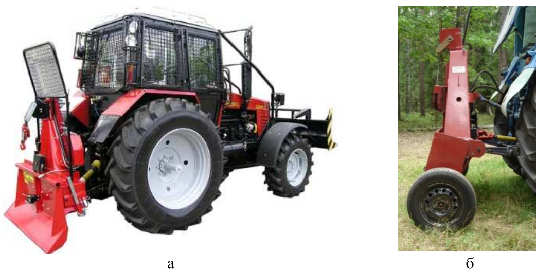
Рисунок 1 – Колесный трелевочный трактор с канатно-чokerным технологическим оборудованием
