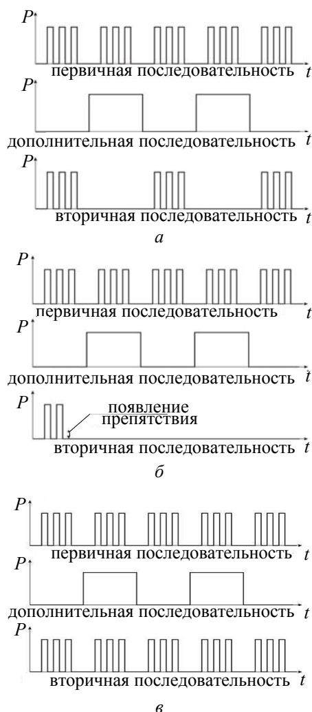
Рис. 7. Моделирование ситуации: а — в отсутствие препятствия и отражателя в зоне чувствительности фотобарьера; б — при наличии препятствия и в отсутствие отражателя в зоне чувствительности фотобарьера; в — в отсутствие препятствия и при наличии отражателя в зоне чувствительности фотобарьера
