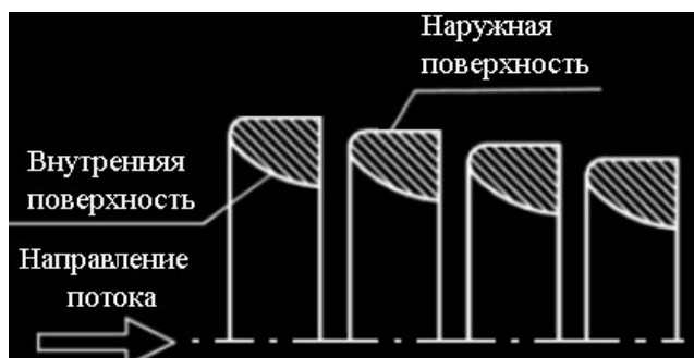
Рисунок 1 – Схема размещения профилированных колец жалюзийного пылеуловителя
