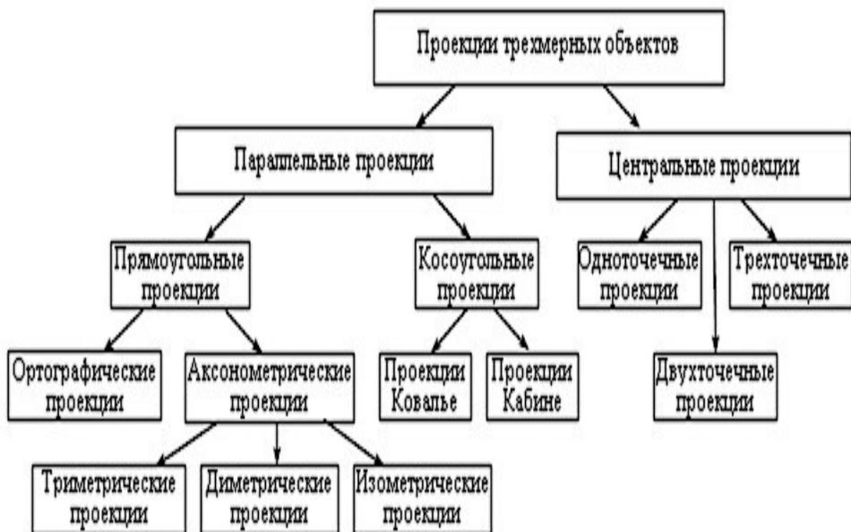
При аксонOMETрической проекции не происходят искажения в горизонтальных и вертикальных размерах, но искажаются размеры, характеризующие глубину объекта. При центральной проекции искажаются все размеры объектов.
