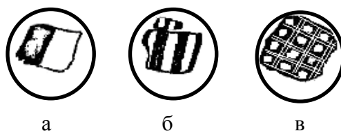
Рис. 22. Двойники под микроскопом: а) простой двойник, б) полисинтетический двойник, в) система пересекающихся двойников.
