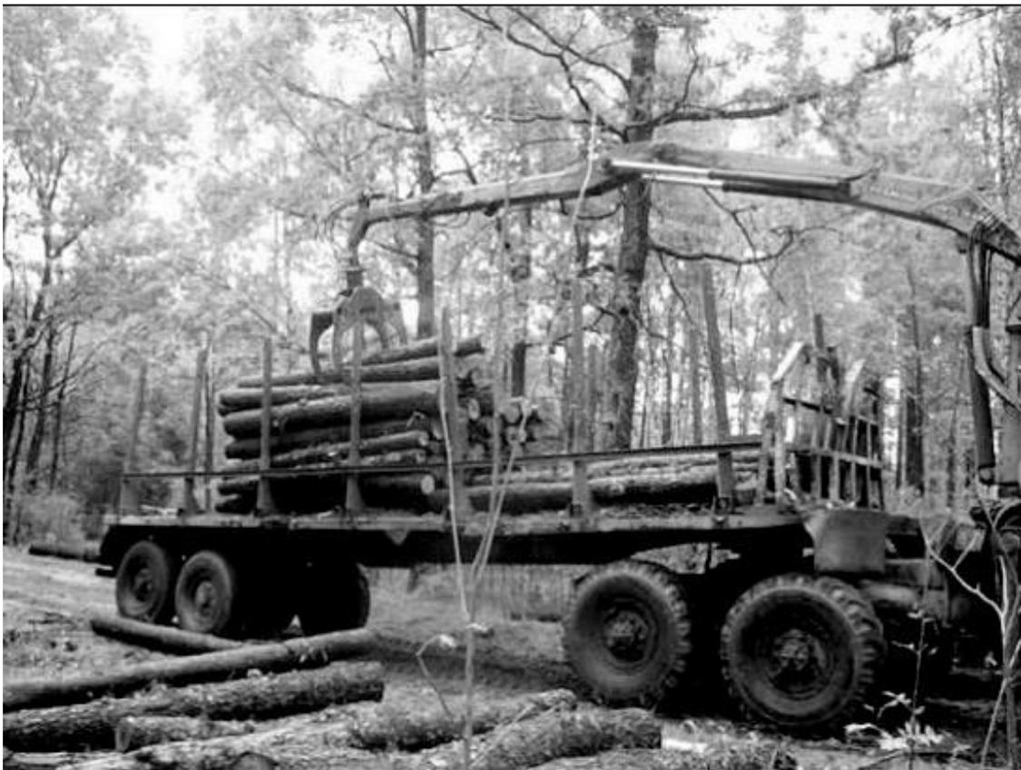
Рис. 4.10. Погрузка сортиментов гидроманипулятором на полуприцеп седельного автопоезда-сортиментовоза
