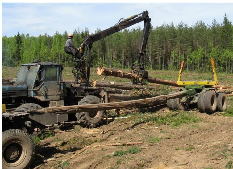
Рис. 4.6. Способ погрузки хлыстов колесным трактором с установленным на нем гидроманипулятором
