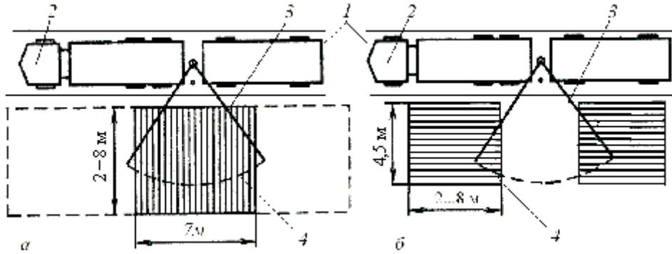
Рис. 4.12. Схемы погрузки сортиментов на автопоезда-сортиментовозы:
