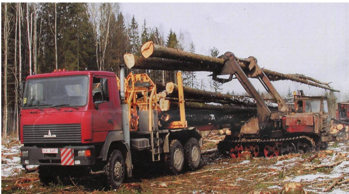
Рис. 4.4. Погрузка лесовозного автопоезда гусеничным челюстным погрузчиком
