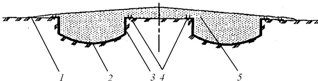
Рис. 3.15. Вариант конструктивной схемы дорожной одежды колеечного типа:
