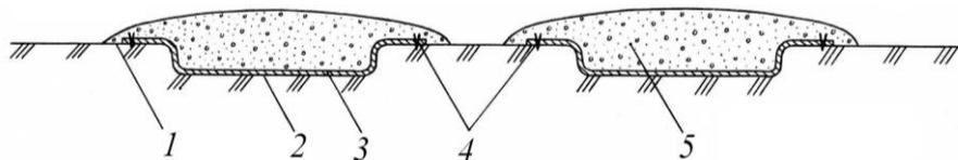
Рис. 3.16. Покрытие колеяного типа с геосинтетическими прослойками:
