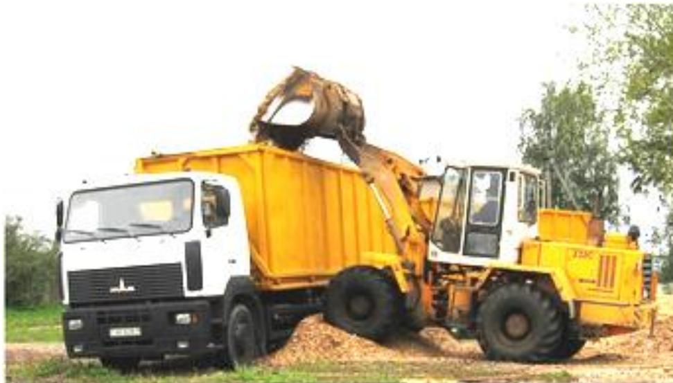
Рис. 4.13. Погрузка щепы в автопоезд-щеповоз погрузчиком «Амкодор»
