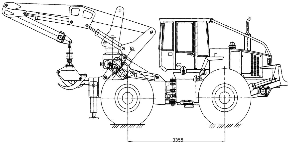
Рис. 4.20. Манипуляторный колесный погрузчик
