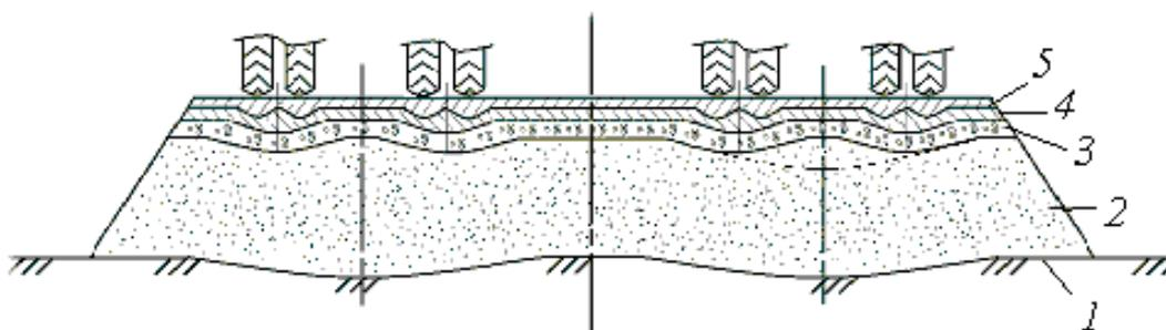
Рис. 3.13. Поперечный разрез дорожной конструкции, устроенной с учетом передачи нагрузки по линиям равных напряжений:
