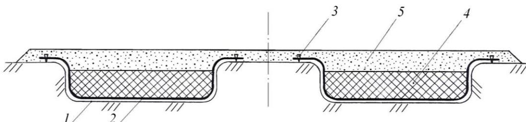
Рис. 3.17. Колеяная дорожная одежда с геосинтетическими материалами и хвостяной выстилкой:
