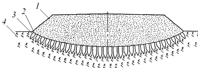
Рис. 3.23. Насыпь на слабых основаниях с укладкой элементов с положительной плавучестью поверхностью на грунт: 1 – грунт насыпи; 2 – синтетический нетканый материал; 3 – элементы с положительной плавучестью; 4 – слабый грунт
