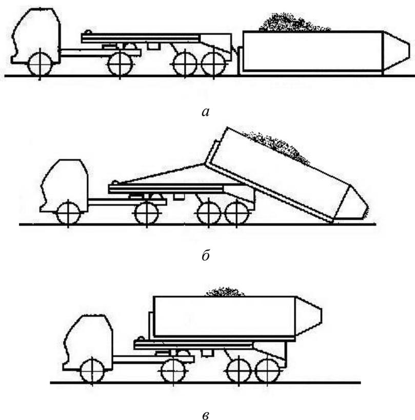
Рис. 4.14. Схема погрузки контейнерного автопоезда-щеповоза:
