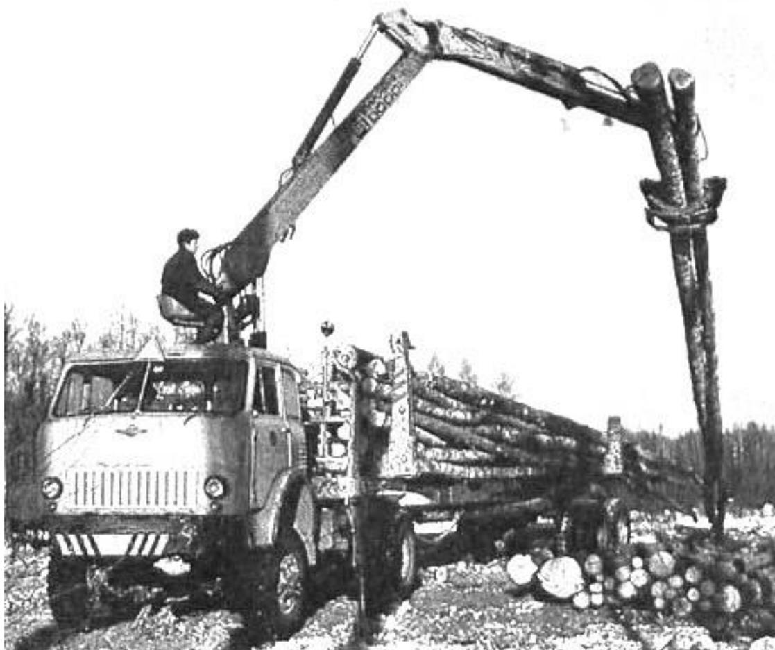
Рис. 4.8. Погрузка хлыстов гидроманипулятором лесовозного автопоезда
