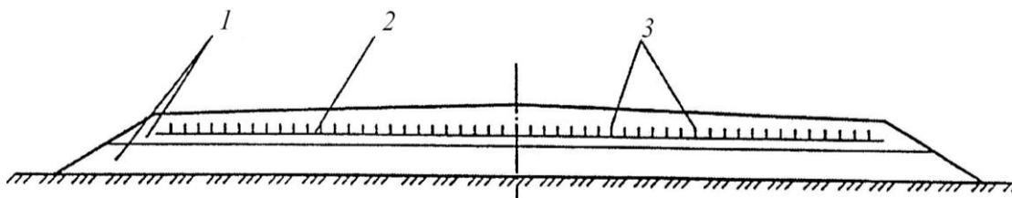
Рис. 3.20. Дорожная конструкция с прослойкой из геосинтетического материала с прикрепленными к нему полосами:
