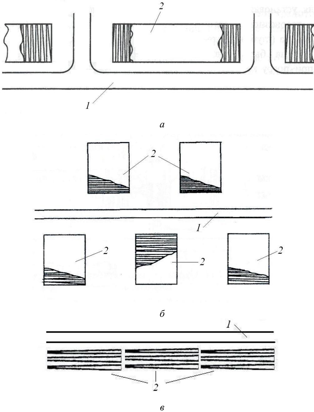
Рис. 4.3. Схемы расположения лесоматериалов в штабелях:
