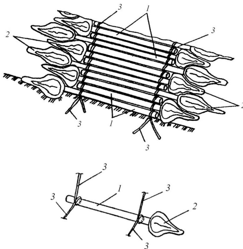
Рис. 3.25. Общий вид настила и способ соединения вершинных частей деревьев:
