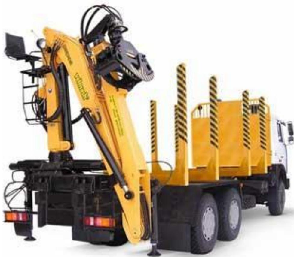
Рис. 4.22. Складной (Z-образный) гидроманипулятор
