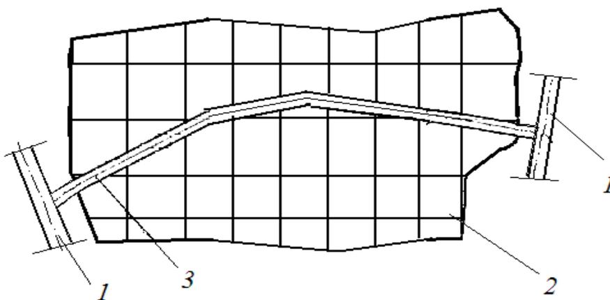
Рис. 3.9. Вариант пересечения магистральной лесной дорогой (3) лесного массива (2) и примыкания ее к дорогам общего пользования (1)
