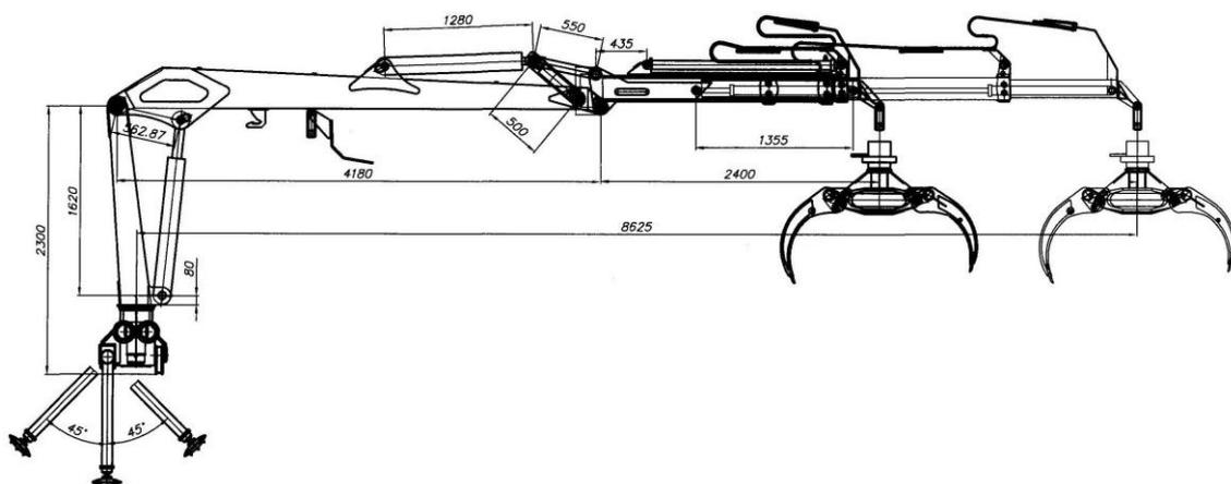
Рис 4.18. Схема гидроманипулятора М 75-04 с увеличенным вылетом стрелы
