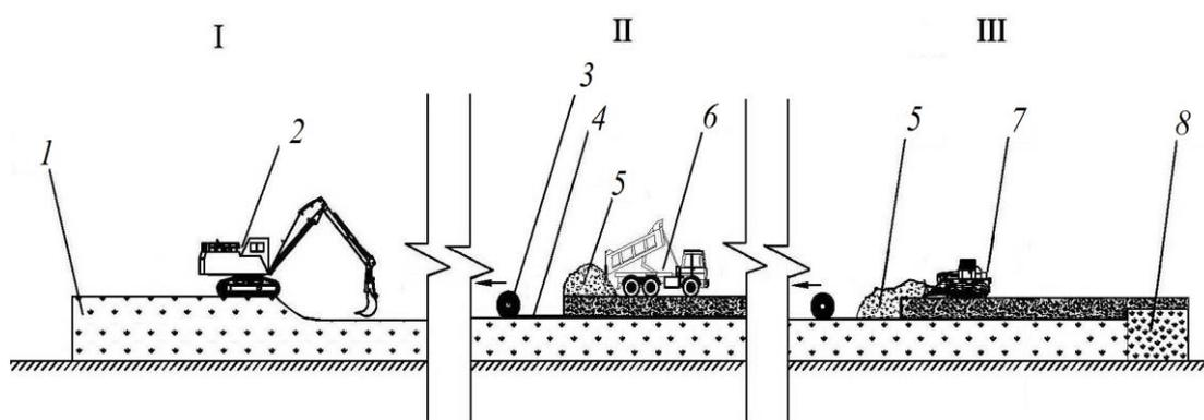
Рис. 3.21. Схема устройства дороги с прослойкой геосинтетического материала на частично выторфованном грунтовом основании:
