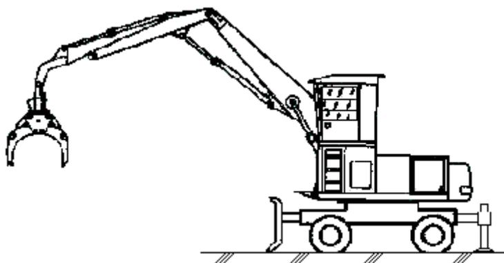
Рис. 4. 21. Общий вид челюстного лесопогрузчика на колесном ходу для погрузки хлыстов и сортиментов
