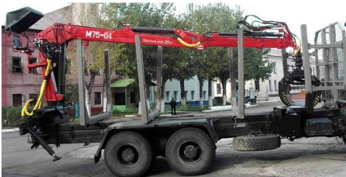
Рис. 4.19. Автомобиль-сортиментовоз МАЗ-6303 с установленным опытным образцом гидроманипулятора М 75-04
