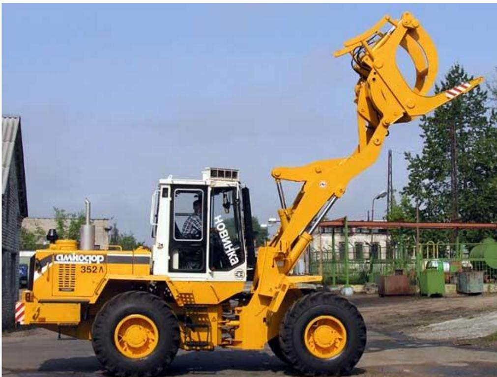
Рис. 4.23. Челюстной погрузчик ОАО «Амкодор» на колесном ходу для погрузки хлыстов и сортиментов
