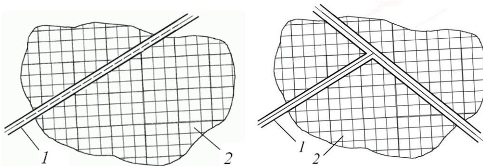
Рис. 3.6. Варианты разделения на части дорогами общего пользования (1) лесного массива: (2)
