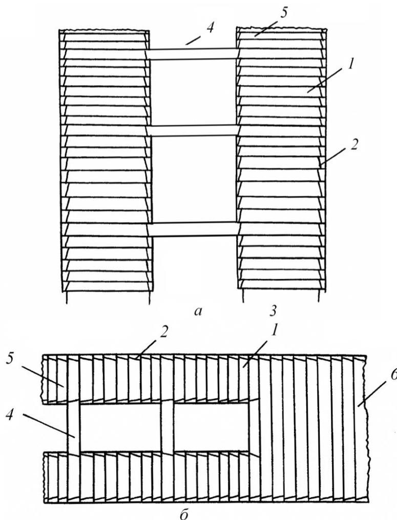
Рис. 3.32. Варианты рулонного покрытия:
