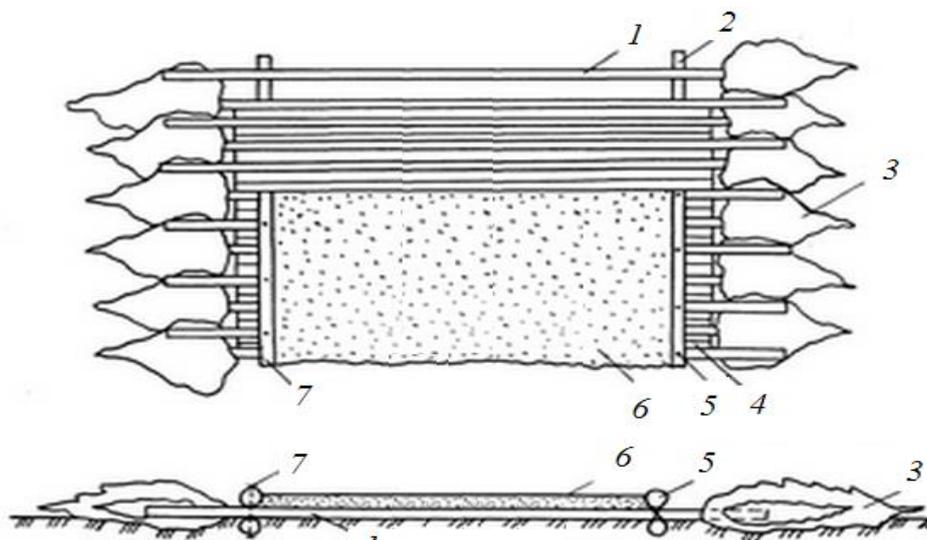
Рис. 3.24. Плавающая конструкция на болотах:
