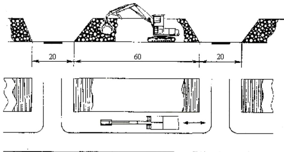
Рис. 4.7. Схема размещения стрелового погрузчика при погрузке хлыстов
