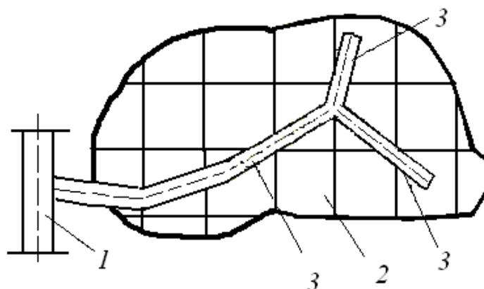
Рис. 3.10. Вариант тупиковой схемы размещения магистральных лесных дорог (3) в лесном массиве (2) с примыканием к дороге общего пользования (1)
