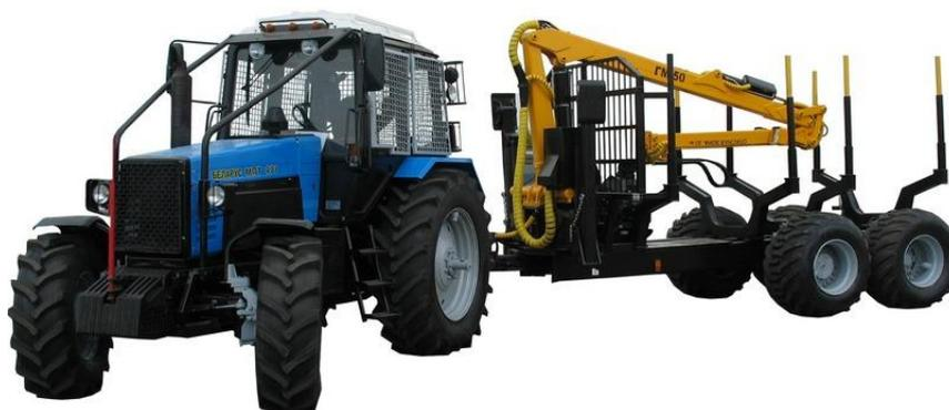
Рис. 3.2. Общий вид машины погрузочно-транспортной
