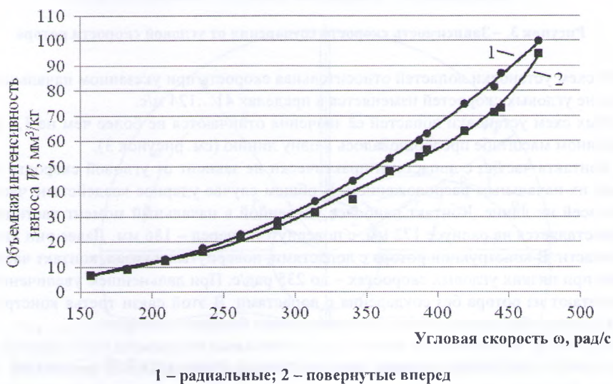
Рисунок 5. – Сравнение конструктивных вариантов роторов по интенсивности износа
