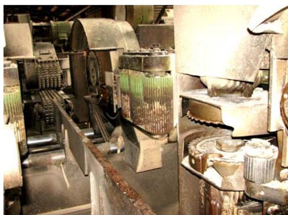
Рис. 2. Фрезерно-пильный станок VPS
