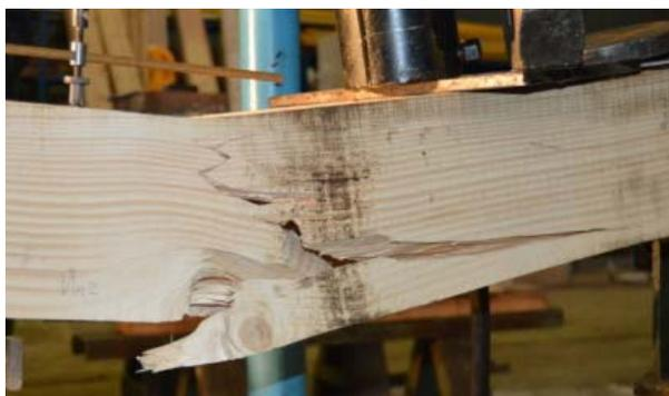
Рис. 6. Разрушение цельной шпалы
