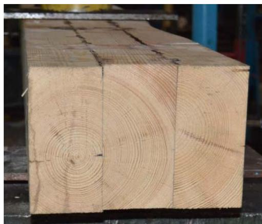
Рис. 1. Комбинированная клееная шпала
