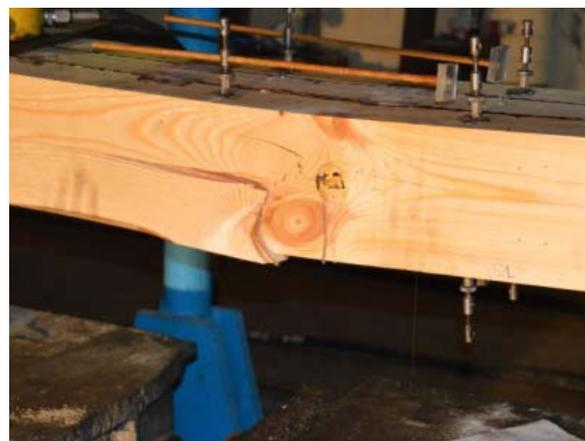
Рис. 8. Разрушение клееной шпалы
