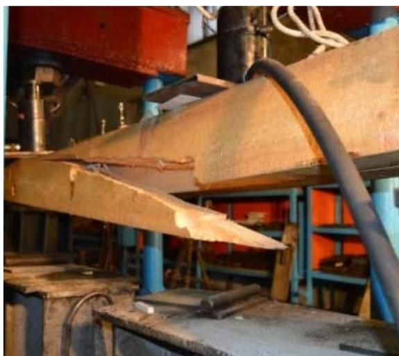
Рис. 7. Разрушение составной шпалы
