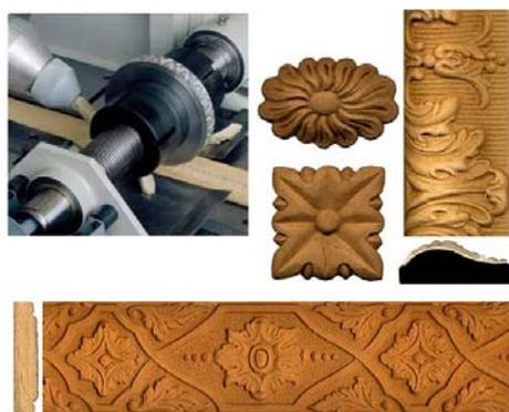
Рис. 7. Декоры, получаемые с использованием древесной пульпы
