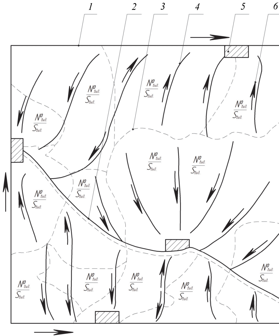
Рис. 4. Схема технологического устройства квартала: 1 – квартальная просека; 2 – лесная дорога; 3 – граница выдела; 4 – пасечные волоки; 5 – промежуточные склады; 6 – направление трелевки (подвозки) лесоматериалов
