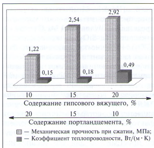
Рис. 4. Зависимость свойств синтезированных материалов от содержания крепителей пеномассы
