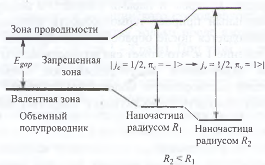
Рис. 1. Схема энергетической структуры объемного полупроводника и полупроводниковых наночастиц разного размера
