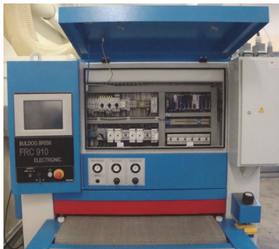
Рис. 10.4. Расположение устройств автоматике машины
