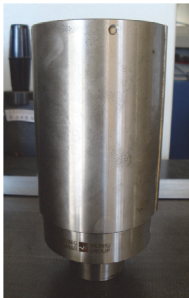
Рис. 8.48. Крепление инструмента без использования гайки: а – хвостовой метод; б – гидравлическая посадка
