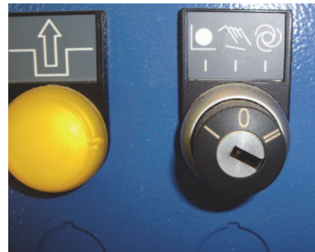
Рис. 8.9. Устройства безопасной эксплуатации Unimat 23 EL: a – система удаления отходов; б – блокировка; в – местное ограждение; г – замок
