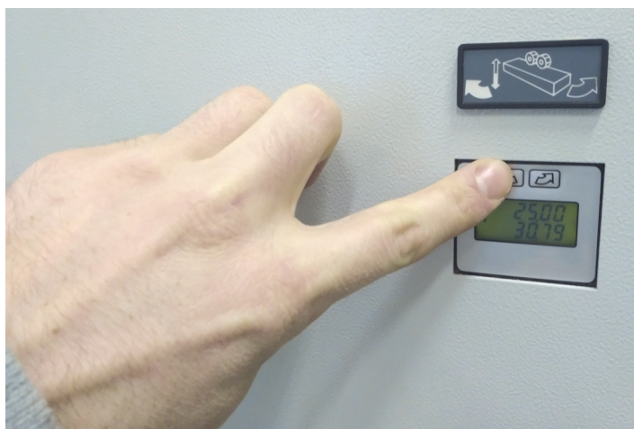
Рис. 8.8. Управление подающей траверсой в вертикальной плоскости
