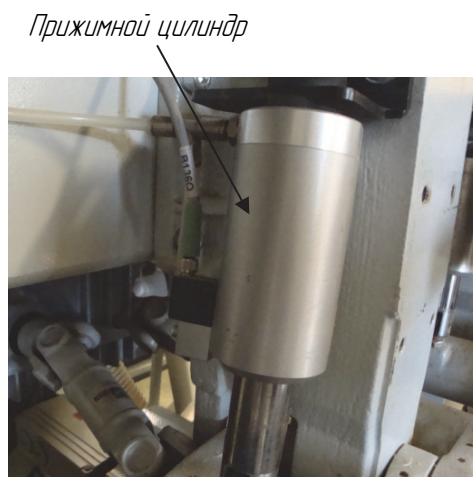
Рис. 8.19. Дросселирование воздуха на прижимные элементы машины
