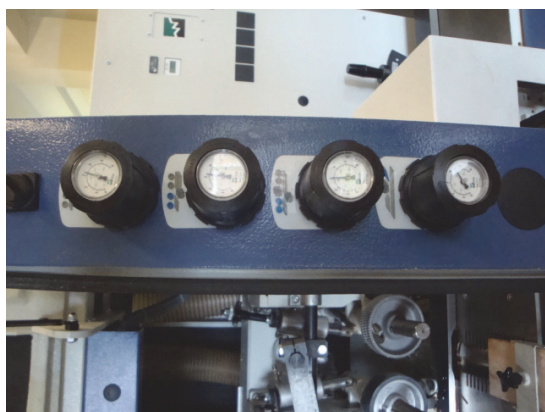
Рис. 8.19. Дросселирование воздуха на прижимные элементы машины
