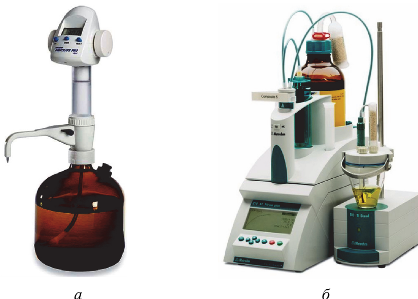
Рис. 4.5. Современное оборудование для титрования: а – цифровая бутылочная бюретка; б – автоматический титратор
