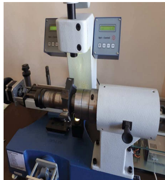
Рисунок 3 – Настройка фрезы с экспериментальным ножом
