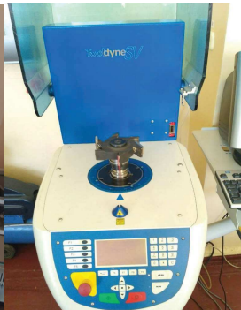
Рисунок 3 – Настройка фрезы с экспериментальным ножом
