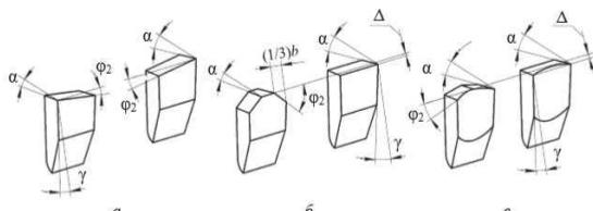
$\gamma$  – передний угол;  $\alpha$  – задний угол;  $\varphi_2$  – угол наклона задней поверхности зуба пилы;  $\Delta$  – разность зубьев по высоте; а – попеременно-косой; б – плоско-трапециевидный; в – плоско-треугольный с вогнутой передней поверхностью
