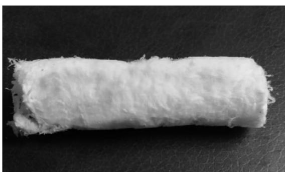
Рисунок 1 – Фотография аэрогеля на основе ИПЭК АЛNa-ХТ
