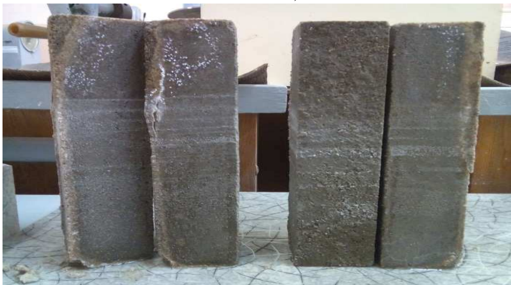
Рисунок 1 – Образцы бетона контрольного состава и состава с добавкой трепела (1% от массы цемента).
