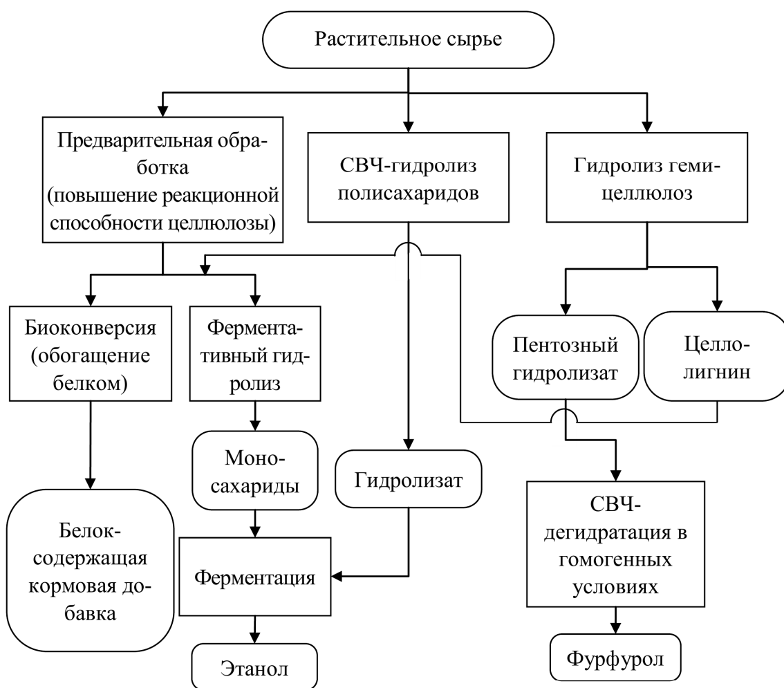
Рисунок – Использование СВЧ-энергии для повышения эффективности гидролитической и биотехнологической переработки растительного сырья
