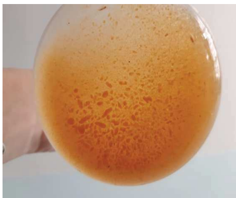
Рисунок 1 – Активный ил на ПБ (7 сутки культивирования)
