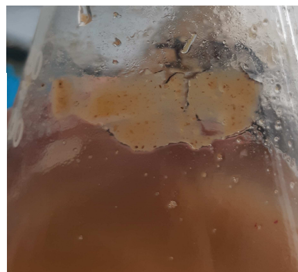
Рисунок 2 – Активный ил на ПБ (20 сутки культивирования)
