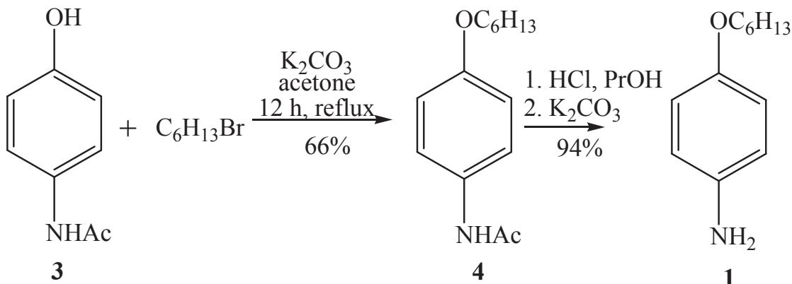
Последующий гидролиз ацетамида **4** позволил выделить целевой амин **1** с количественным выходом.
