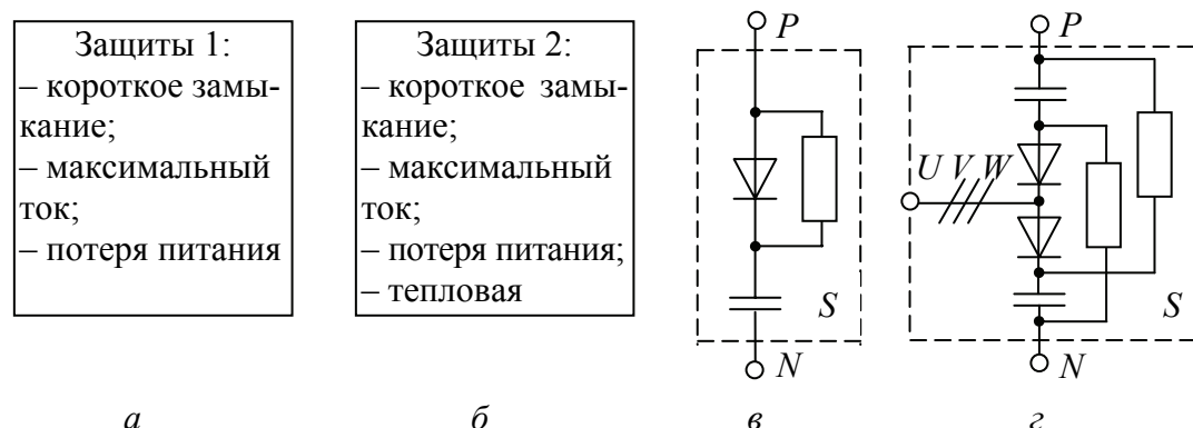
Рис. 12.4. Элементы интеллектуального модуля: а, б – содержание блоков «Защиты 1», «Защиты 1»; в – полумостовая схема; г – одиночный модуль
