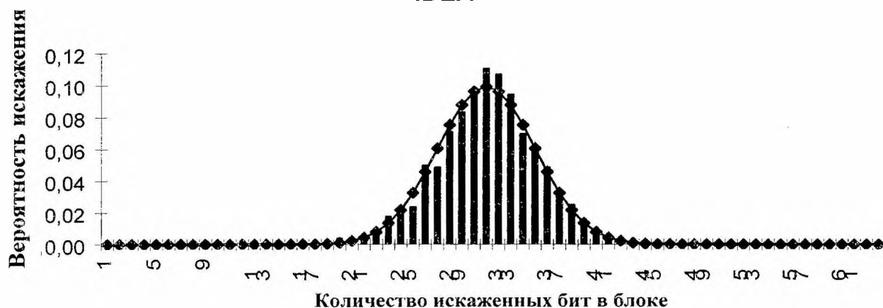
Рис. 1. Гистограммы зависимости количества искаженных бит в блоке при введении единичной ошибки в шифротекст; экспериментальные (столбцы) и теоретические (линия с точками) данные
