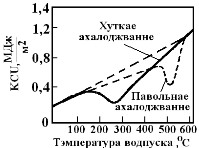
Мал. 95. Схема ўздзеяння тэмпературы водпуску і хуткасці ахалоджвання пасля водпуску на ўдарную вязкасць
