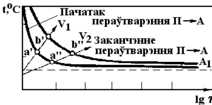
Мал. 74. Дыяграма ізатэрмічнага пераўтварэння перліту ў аўстэніт эўтэктоіднай сталі: a^I, a^{II} - пункты пачатку і b^I, b^{II} - пункты канца пераўтварэння P \rightarrow A з хуткасцямі v_1, v_2 ( v_1 > v_2 )
