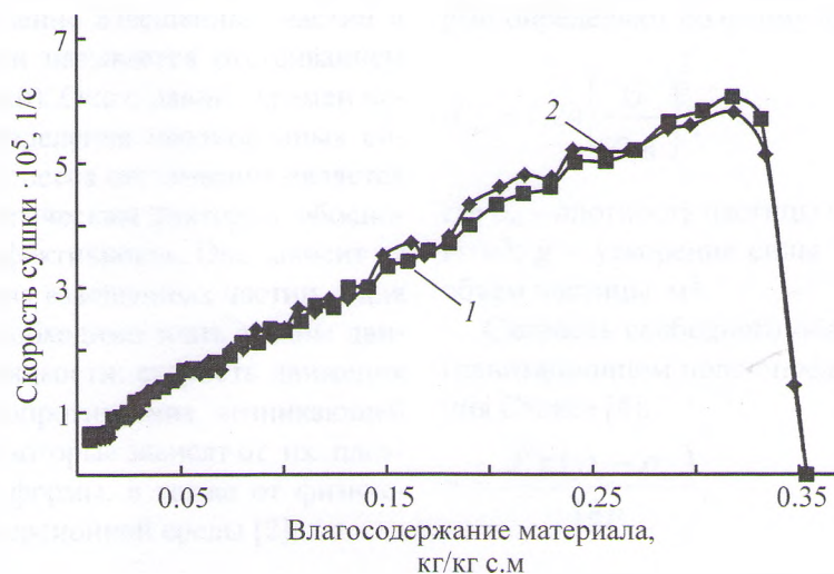
Рис. 3. Кривые скорости сушки: 1 – весовой метод; 2 – по параметрам воздуха.
