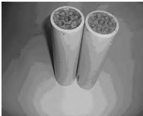
Рис. 8. Модули на основе пористых алюмосиликатных элементов для стерилизующей очистки культуральных жидкостей
