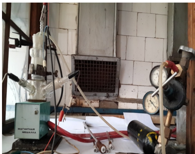
Рисунок 2 – Установка для моделирования технологических условий протекания коррозионных процессов в скважине: слева- электрохимическая трехэлектродная ячейка, справа – устройство для аэрации агрессивной среды различными газами.
