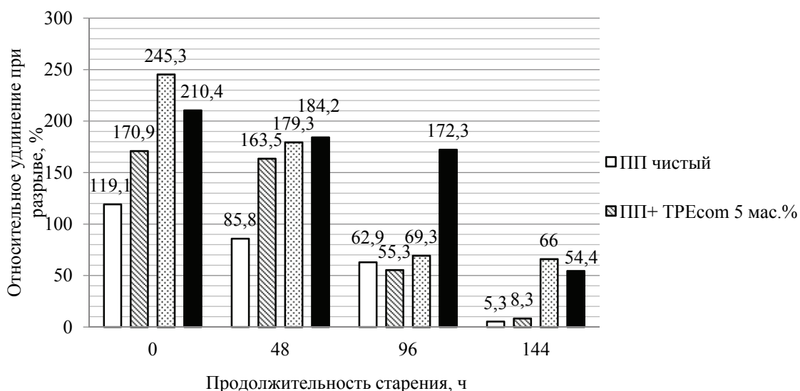
Рисунок 2 - Изменение относительного удлинения при разрыве ПП в зависимости от содержания ТЭП TPE com Natural и продолжительности старения
