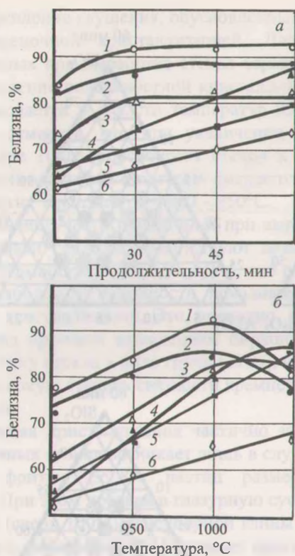
Рис. 2. Зависимость белизны покрытий от продолжительности термообработки при 950°C (а) и температуры обжига (б) 1 — 23; 2 — 22; 3 — 11; 4 — 20; 5 — 10; 6 — 9
