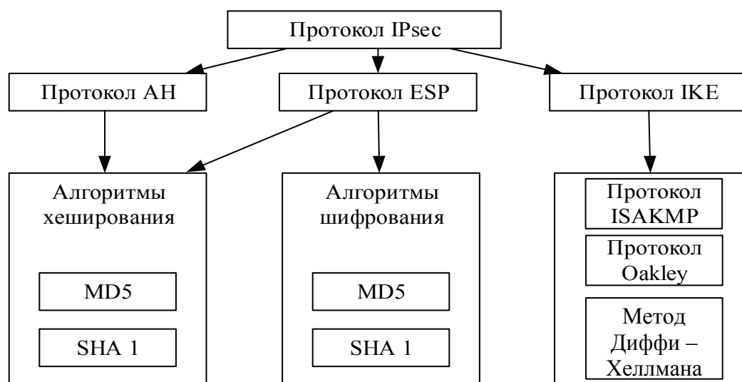
Рис. 7.6. Структура протокола IPsec
