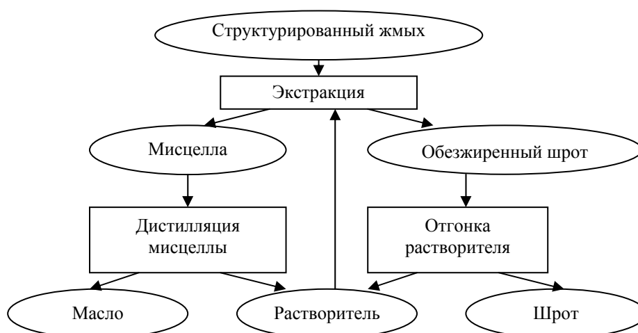
Рис. 47. Технологическая схема экстракционного процесса
