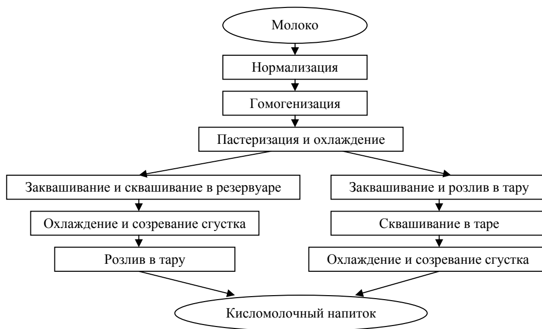
Рис. 57. Технологическая схема производства кисломолочных напитков
