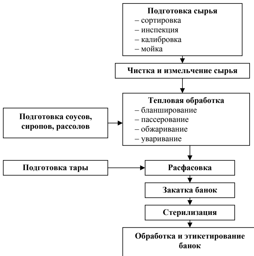
Рис. 45. Технологическая схема получения баночных плодовоовощных консервов
