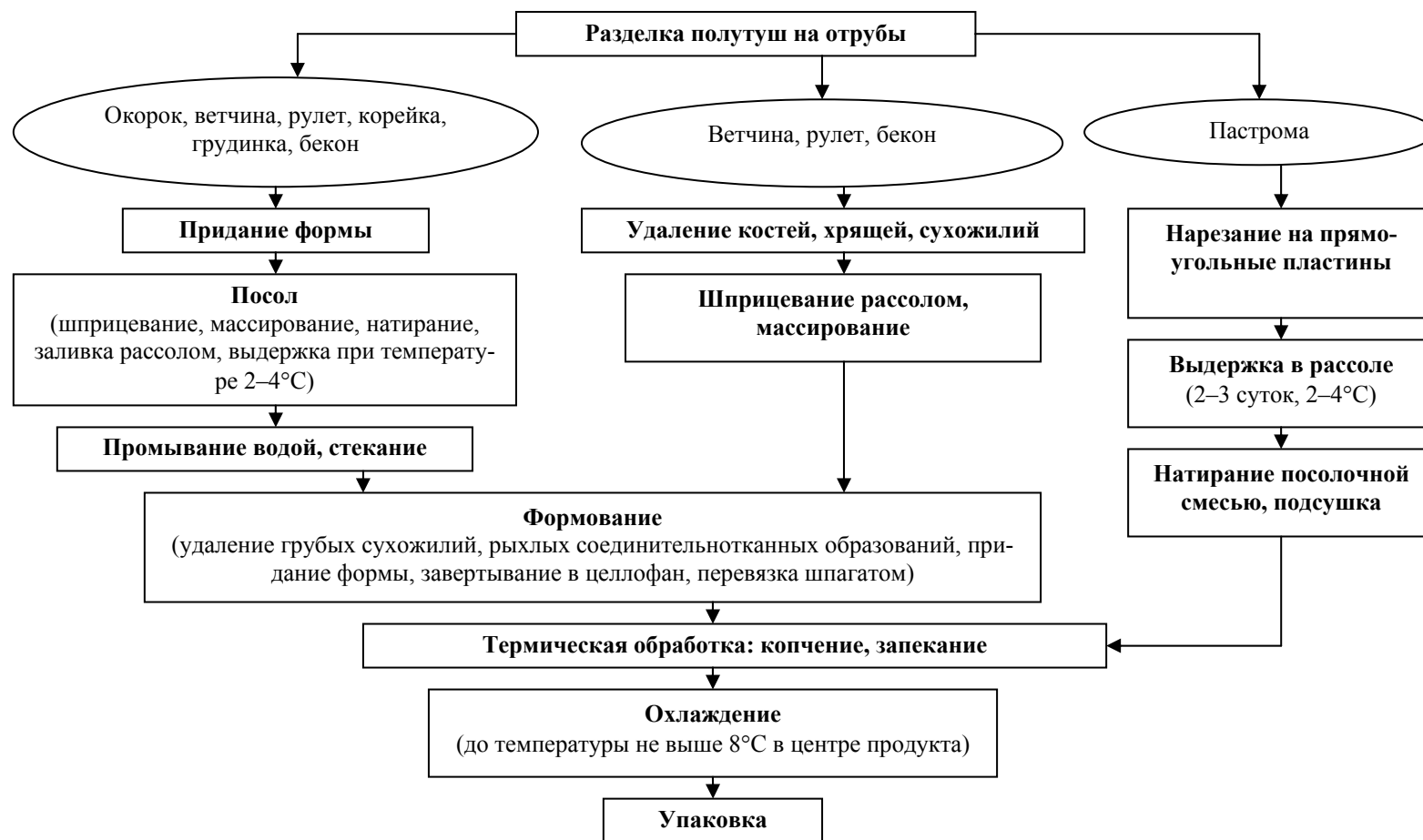
Рис. 72. Технологическая схема производства продуктов из свинины (ококорков, ветчины, рулетов, корейки, грудинки, бекона, пастромы)
