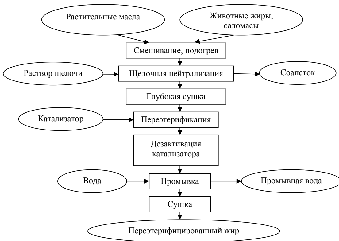
Рис. 49. Технологическая схема переэтерификации жиров и масел
