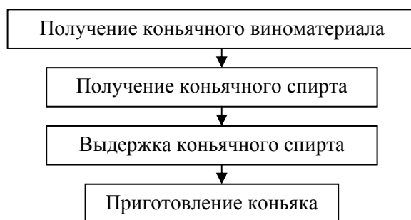
Рис. 27. Технологическая схема получения коньяка
