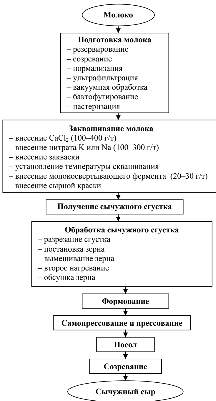
Рис. 61. Технологическая схема получения сычужных сыров
