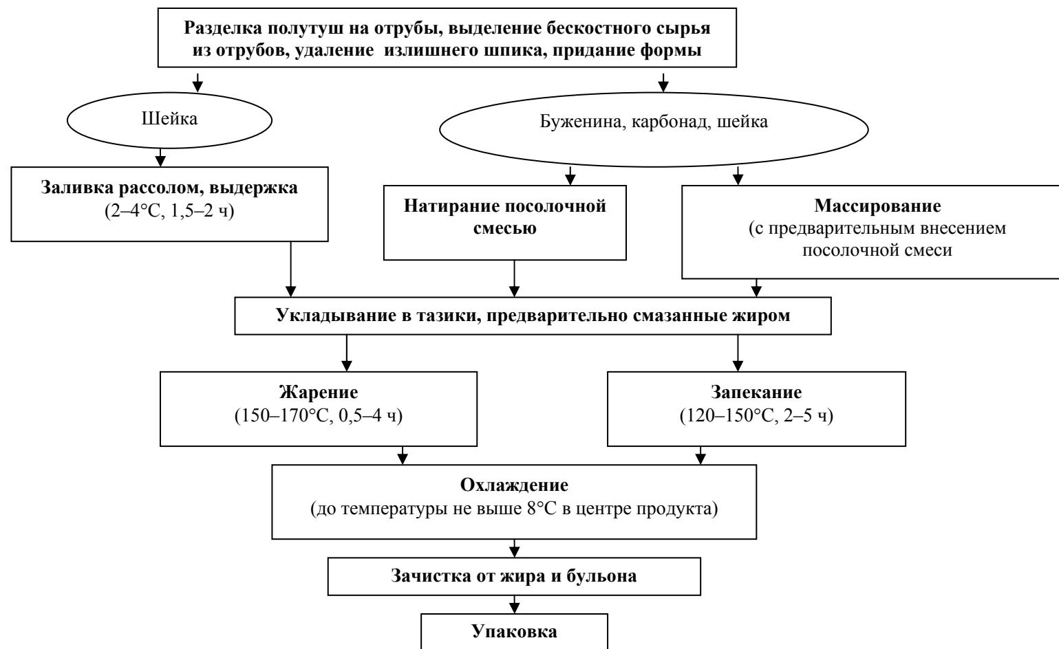
Рис. 73. Технологическая схема производства запеченных и жареных продуктов из свинины (буженина, карбонад, шейка)
