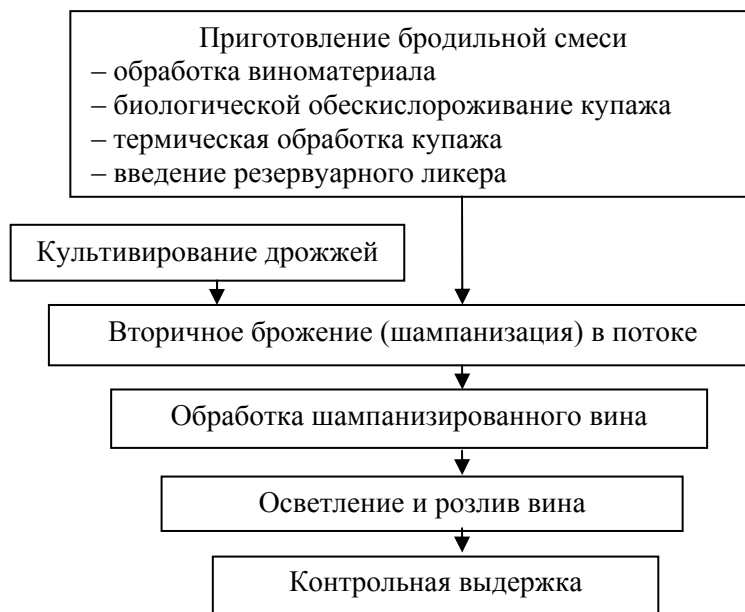
Рис. 21. Технологическая схема получения «Советского шампанского» непрерывным способом
