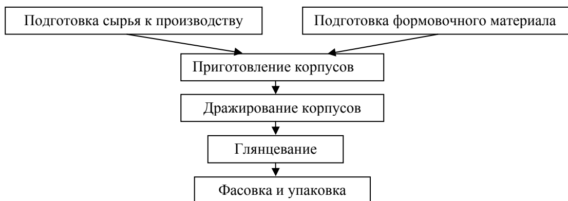
Рис. 33. Технологическая схема получения драже
