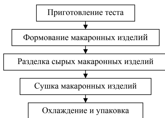
Рис. 44. Технологическая схема производства макаронных изделий
