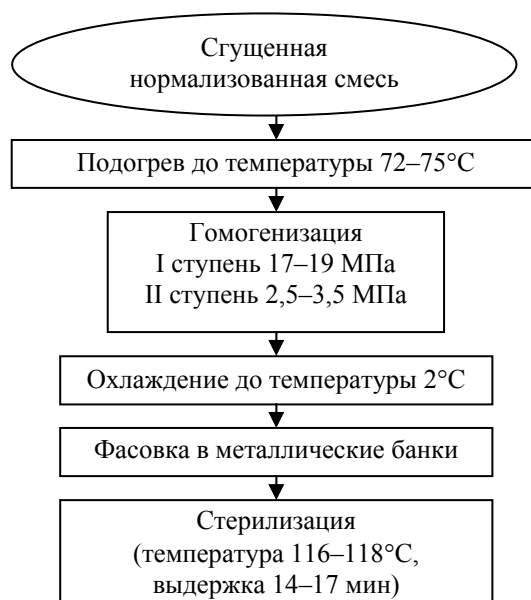
Рис. 67. Технологическая схема получения сгущенных стерилизованных молочных консервов
