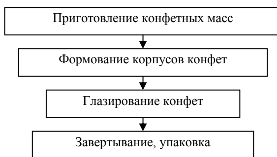
Рис. 29. Технологическая схема приготовления конфет
