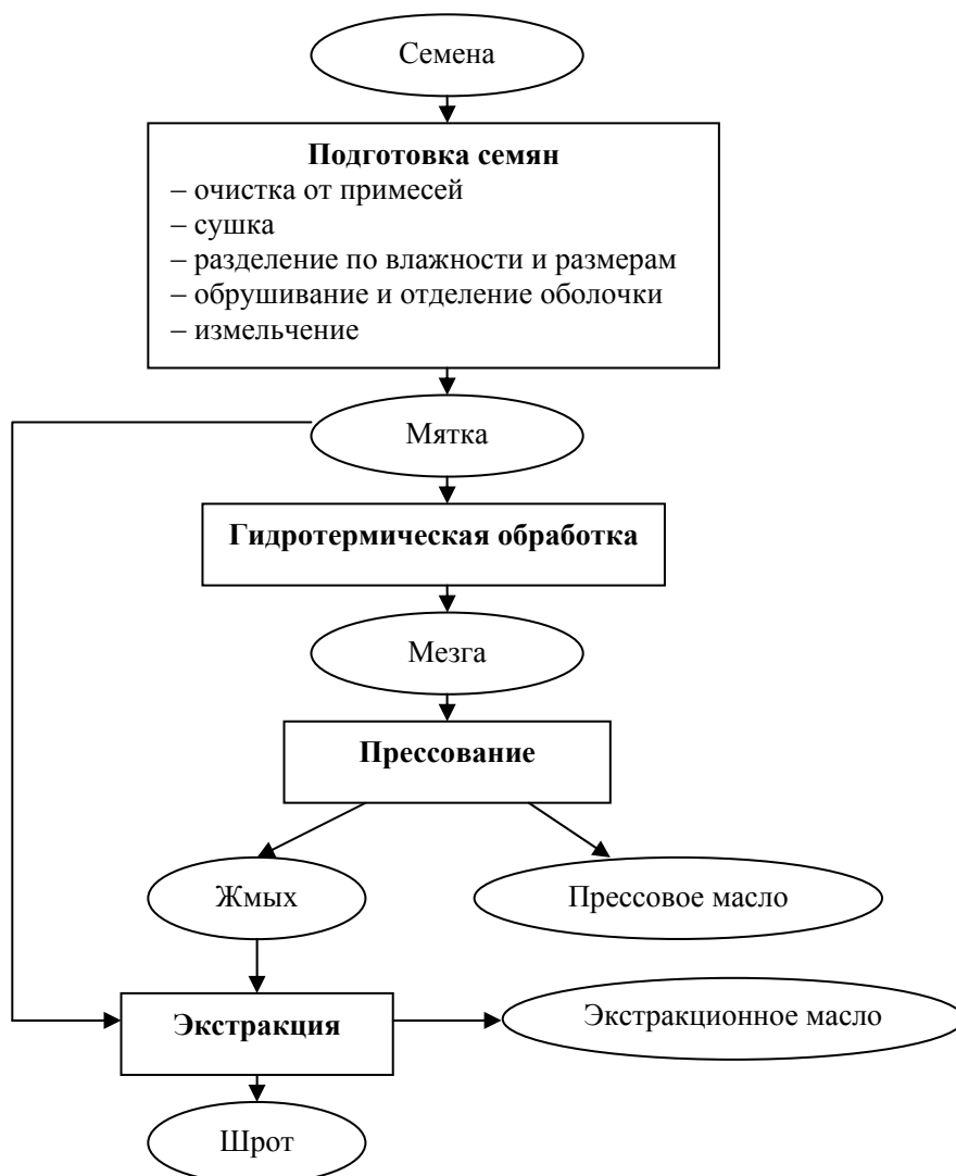
Рис. 46. Технологическая схема получения растительных масел
