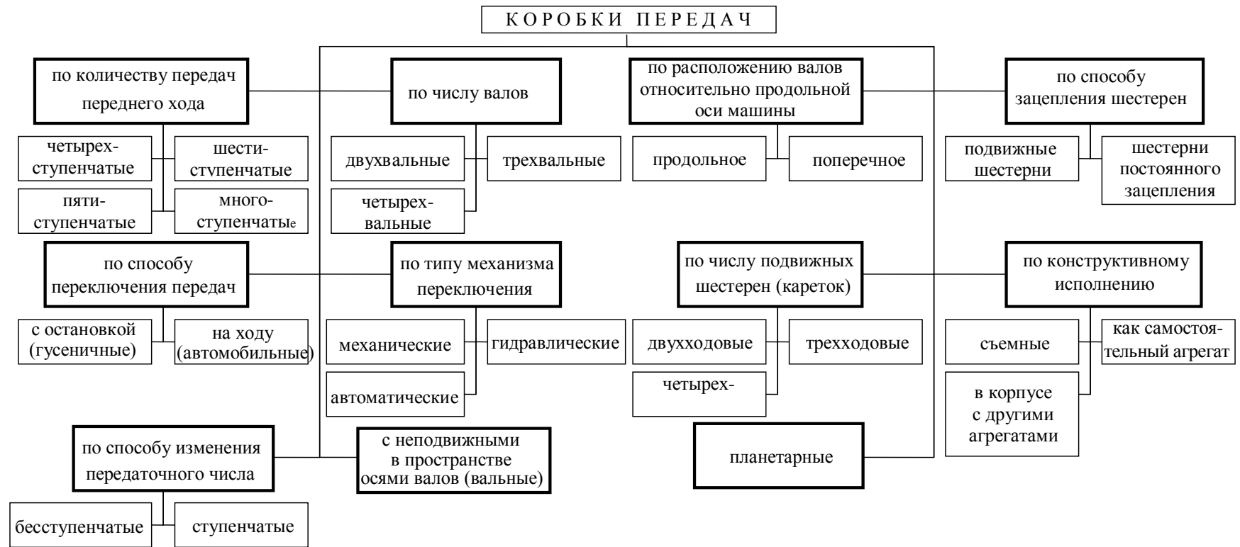
Рис. 2.85. Классификация коробок передач
