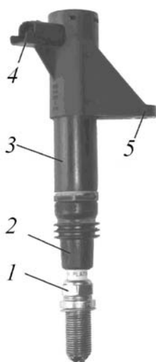
Рис. 2.66. Электронная катушка зажигания в сборе со свечой зажигания: 1 – свеча зажигания; 2 – предохранительный резиновый уплотнительный конус; 3 – металлический корпус катушки; 4 – электрический разъем управления; 5 – крепежный кронштейн
