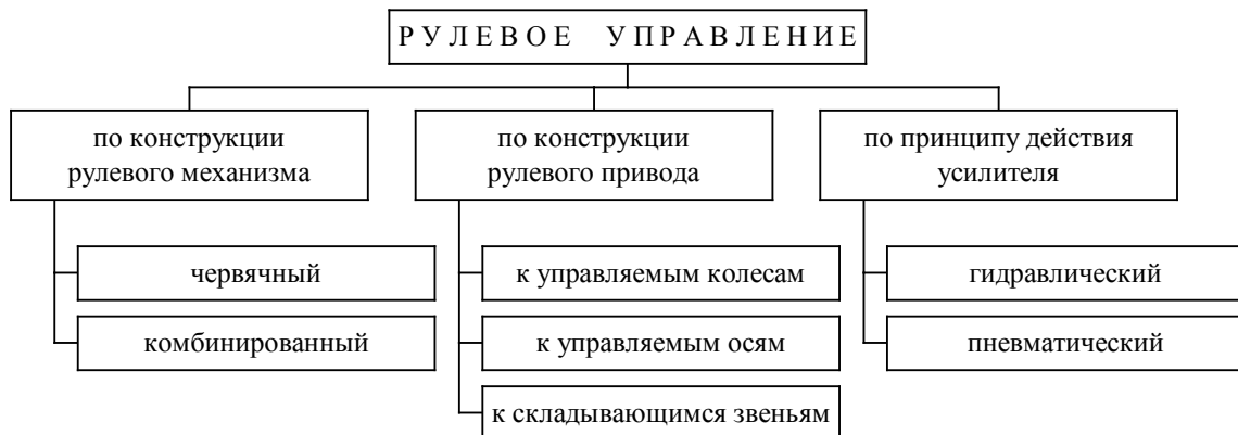
Рис. 2.120. Классификация рулевых управлений
