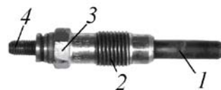
Рис. 2.70. Свеча накаливания: 1 – рабочий стержень накаливания; 2 – установочная резьба; 3 – шестигранная головка под ключ; 4 – контактная головка
