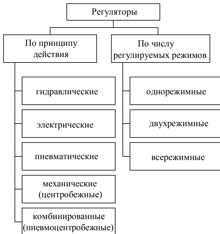
Рис. 2.53. Классификация автотракторных регуляторов
