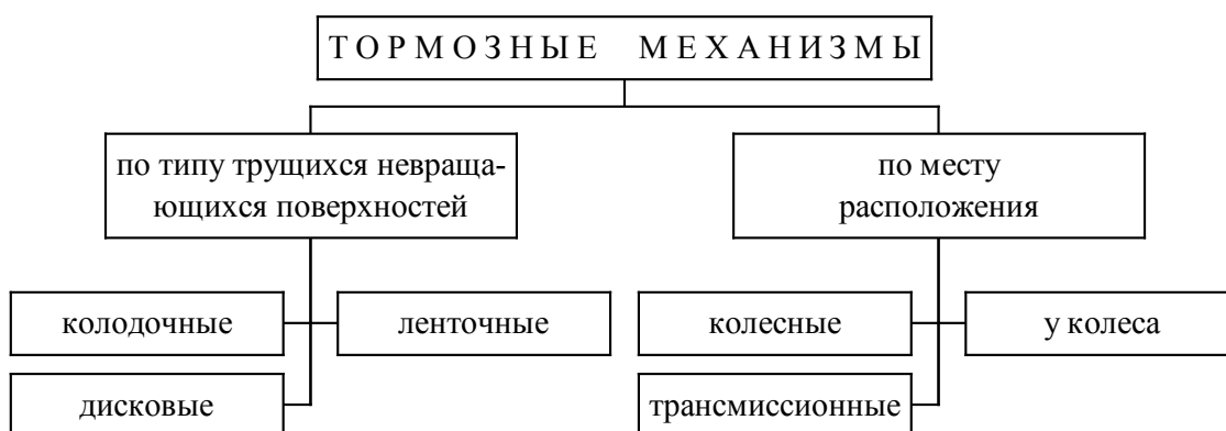
Рис. 2.126. Классификация тормозных механизмов
