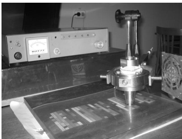
Рисунок 4. – Опытная ультразвуковая установка
