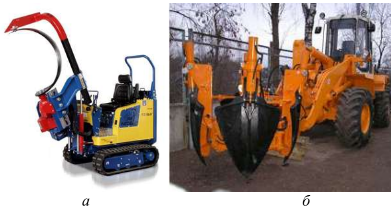
Рис. 2.17. Машина для выкапывания деревьев: a – FZ 110 PLUS; б – Optimal Opitz 1400
