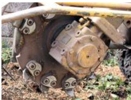
Рис. 2.8. Измельчители пней: а – дисковый; б – роторный
