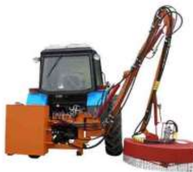
Рис. 1.7. Косилка-кусторез: а – ЕМ-1,3; б – ЕМ-1,3-01 с режущей головкой
