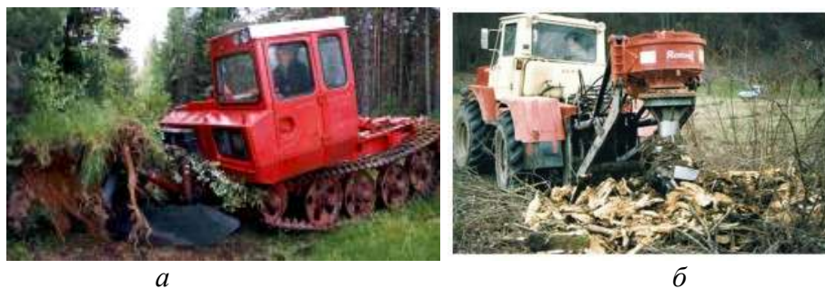
Рис. 2.1. Корчевальные машины: а – фронтальная навеска спереди базового трактора; б – с задним расположением рабочего органа
