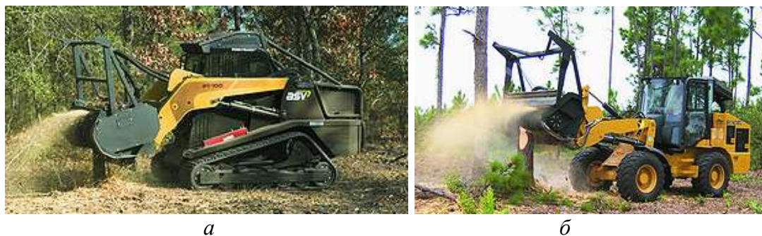
Рис. 2.12. Мульчер: а – гусеничный; б – колесный
