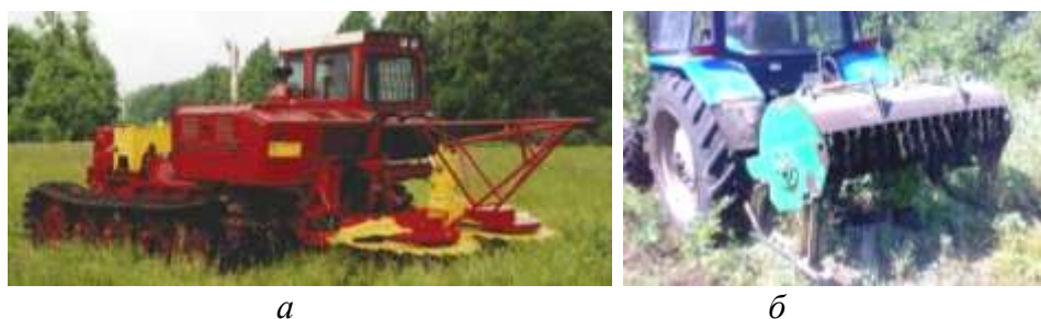
Рис. 1.8. Кусторезы: а – КТГ-2,4; б – РКР-1,5
