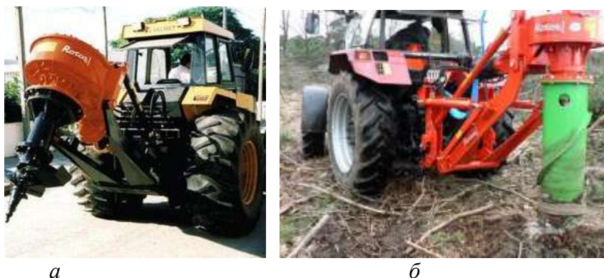
Рис. 2.10. Измельчители пней Stumper: а – роторный; б – цилиндрический
