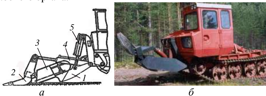
Рис. 2.2. Корчевальная машина КМ-1: а – схема ( 1 – рама; 2 – клыки корчеватели; 3 – отвал; 4 , 5 – гидравлическая система поворота и подъема рабочего органа); б – общий вид
