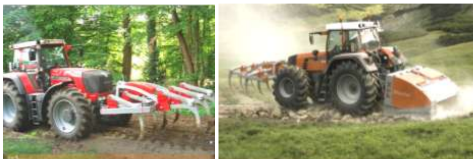
Рис. 3.13. Навесной рыхлитель и камнедробилка колесного трактора
