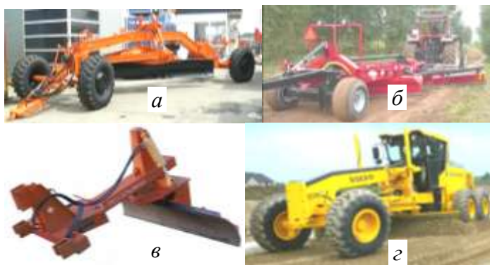
Рис. 5.1. Способы агрегатирования грейдеров: а – прицепной; б – полуприцепной; в – навесной; г – самоходный
