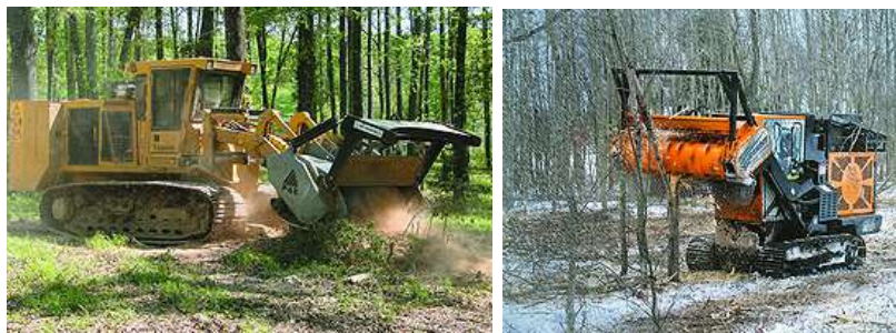
Рис. 2.16. Самоходные мульчеры с гидравлическим приводом: а – FAE; б – Bandit 3500
