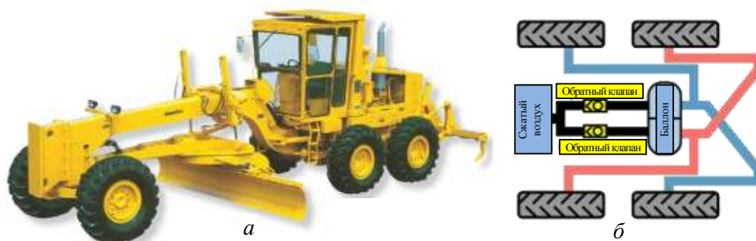
Рис. 5.11. Автогрейдер Komatsu GD-750A-1: а – общий вид; б – пневматическая тормозная система
