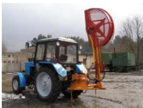
Рис. 1.7. Косилка-кусторез: а – ЕМ-1,3; б – ЕМ-1,3-01 с режущей головкой
