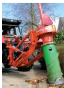
Рис. 2.8. Измельчители пней: а – дисковый; б – роторный
