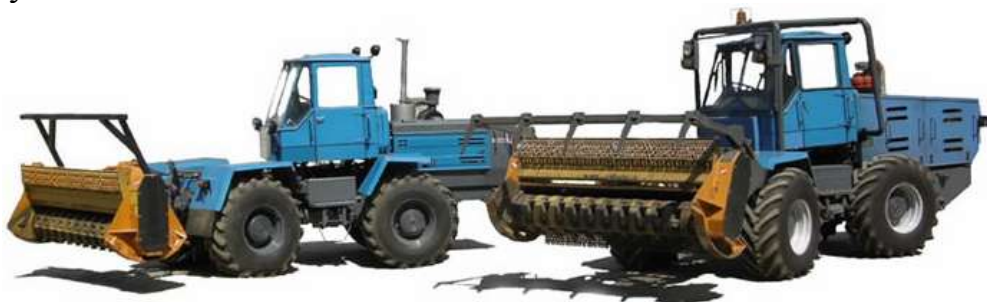
Рис. 1.9. Фронтальный измельчитель на базе трактора ОпТЗ-150К
