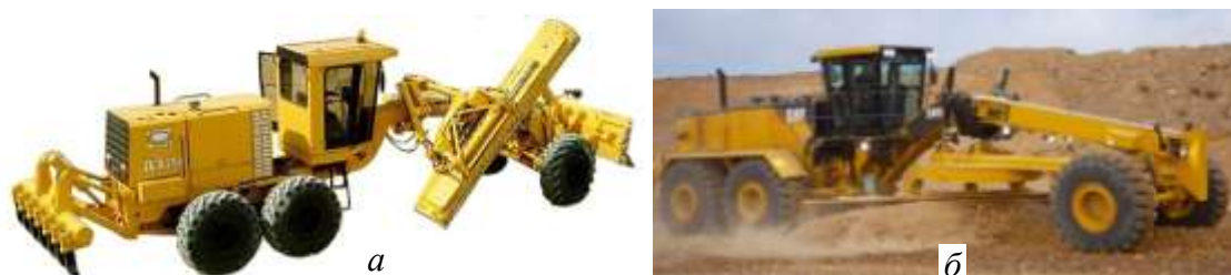
Рис. 5.9. Автогрейдеры: а – ДЗ-298; б – 24М
