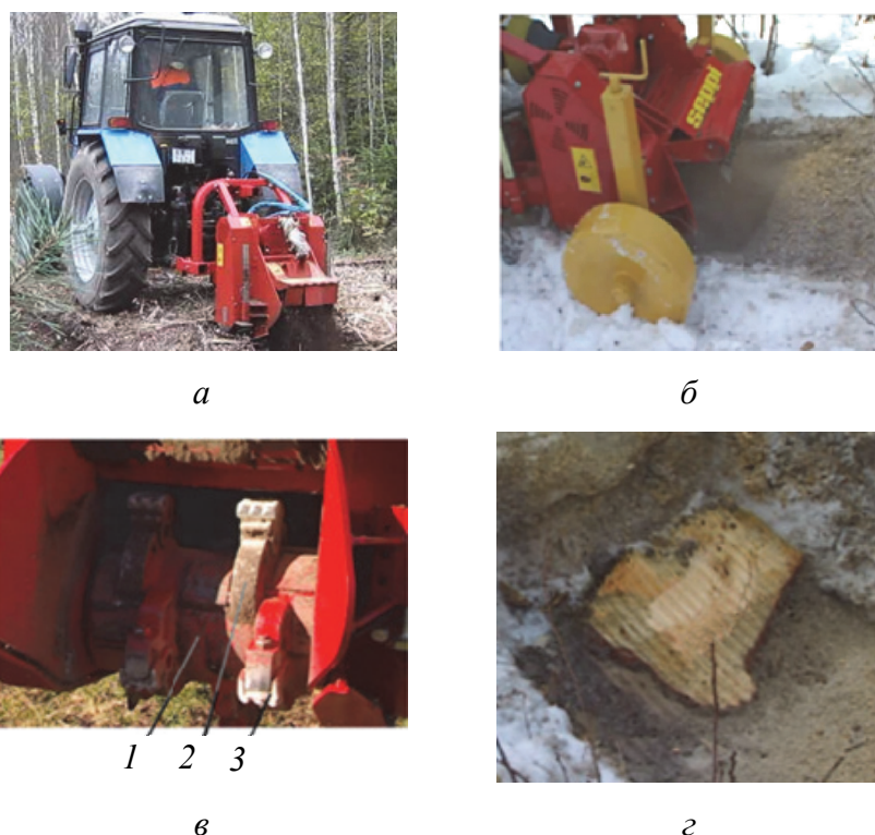
Рис. 1.5. Почвенная фреза: а, б – обработка почвы; в – роторный рабочий орган: 1 – ротор; 2 – нож-резец; 3 – наконечник; г – понижение пня
