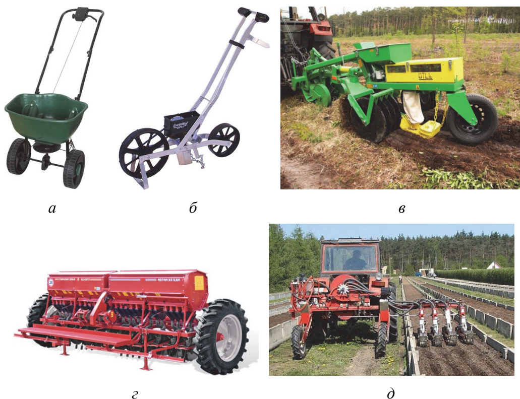
Рис. 6.1. Сеялки: тачечная (а), ручная (б), лесная (в), сельскохозяйственная (г), лесопитомниковая (д)
