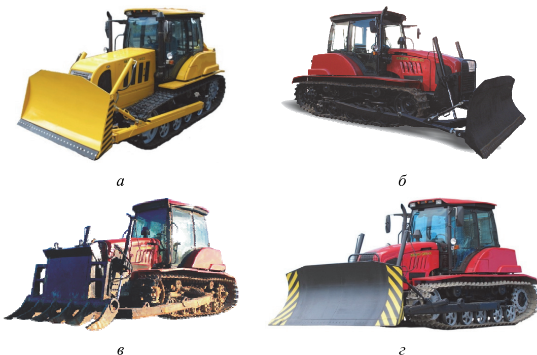
Рис. 2.6. Типаж гусеничных машин «БЕЛАРУС»: а – бульдозер МТЗ-1402; б – бульдозер промышленный МТЗ-1502; в – корчеватель МП-18-6; г – бульдозер мелиоративный МТЗ-1502
