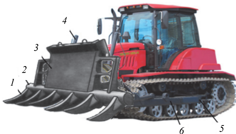
Рис. 1.2. Навесное оборудование корчевателя МП-18: 1 – зуб; 2 – балка; 3 – толкатель; 4 – гидроцилиндр; 5 – шарнир; 6 – универсальная толкающая рама
