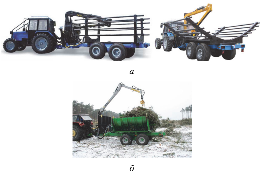
Рис. 1.7. Подборщики манипуляторного типа: а – оборудование полуприцепа лесовозного «БЕЛАРУС» ОПЛ; б – пакетировщик порубочных остатков LZB
