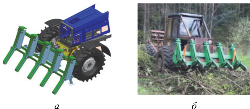
Рис. 1.6. Подборщик сучьев грабельного типа: а – оборудование уборочное лесохозяйственное ОУЛ-24; б – процесс сгребания в валы
