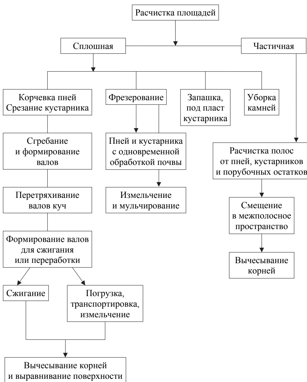
Рис. 1.1. Виды расчистки лесных площадей
