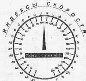
Рис. 2.2. Индексы категорий скорости и соответствующие скорости, применяемые при эксплуатации шин
