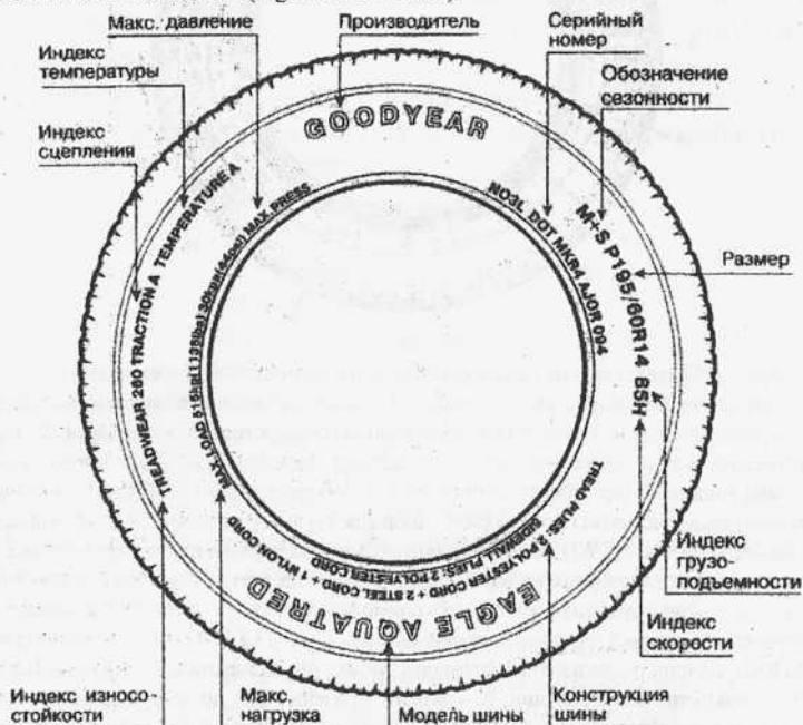
Рис. 2.4. Обозначения на шинах для американского рынка
