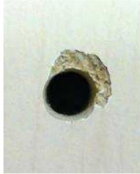
Рис. 2. Дефект обработки сверлением
