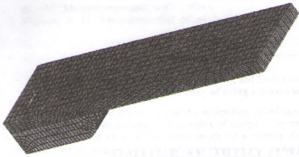
Рис. 1. Схема разбивки балки на конечные элементы
