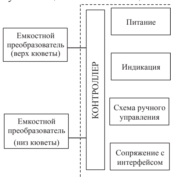
Рисунок 1 - Функциональные блоки преобразователя
