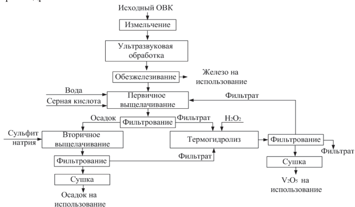
Рисунок 1 – Принципиальная схема переработки ОВК
