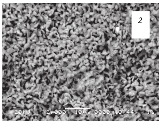
Рисунок 3 - Микрофотографии поверхности сколов (перпендикулярно оси прессования) керамики \text{Ca}_3\text{Co}_4\text{O}_{9+\delta} : 1 – образец A ; 2 – образец B
